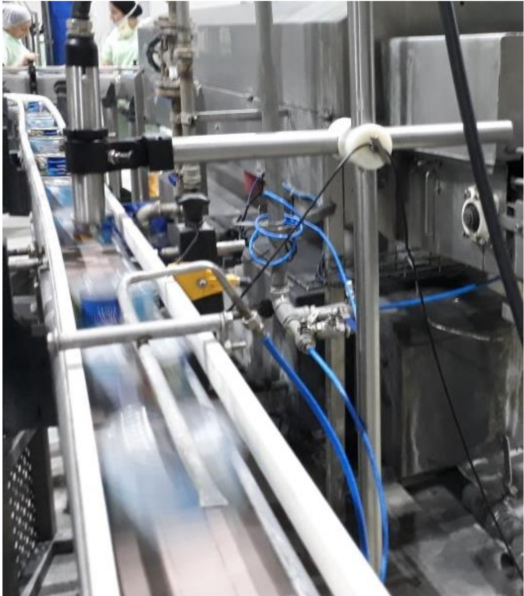
Figura 3-9: Punto de aire para secar las latas antes de ser codificadas.
