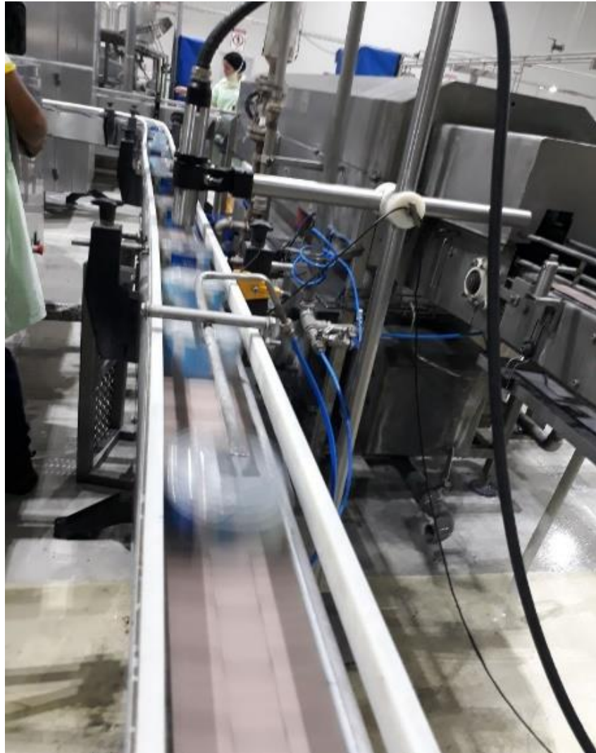
Figura 3-3: Línea de producción de atún de alta velocidad.
