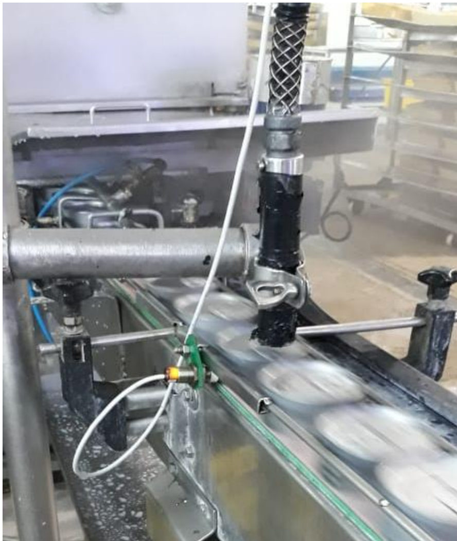
Figura 3-11: Sensor inductivo independiente al cabezal de impresión.
