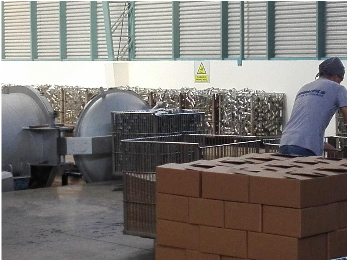
Figura 2-8: Latas después del esterilizado para su codificación en el etiquetado.
