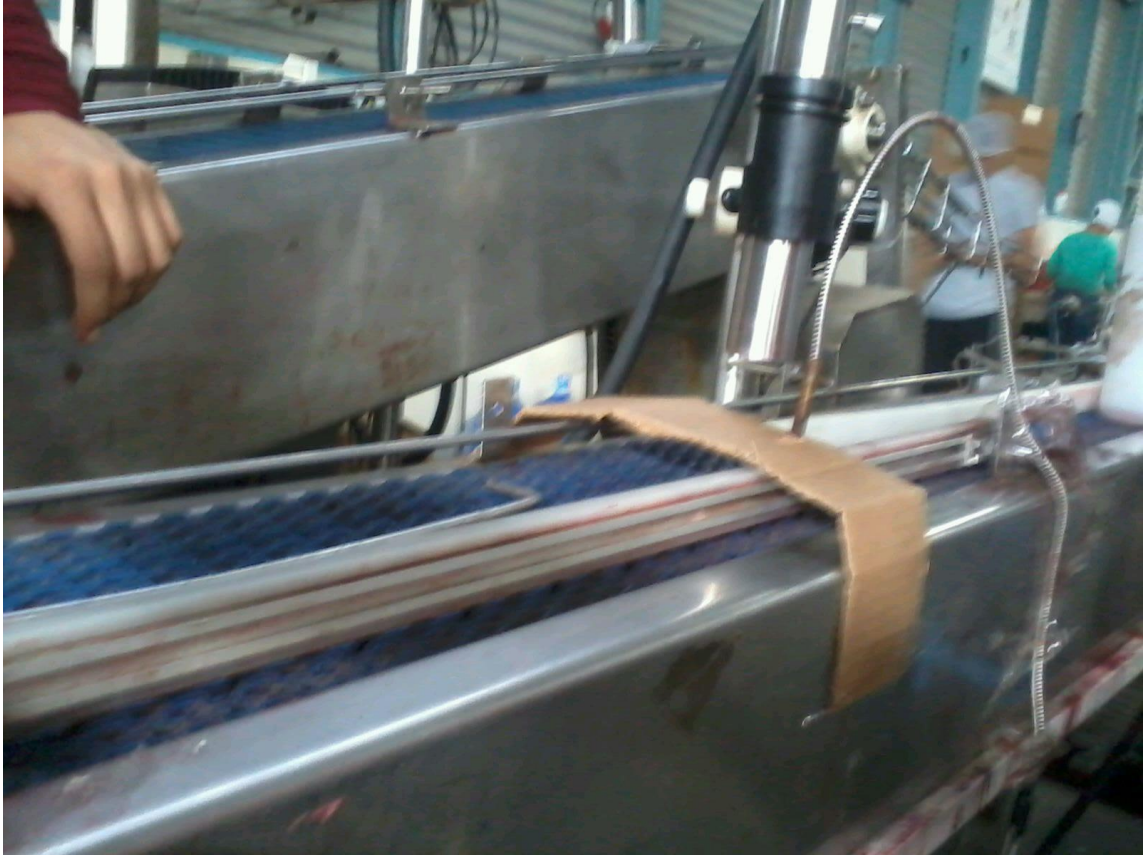
Figura 2-7: Línea de producción con sensor de fibra óptica, utilización anti-técnica del sensor y presenta errores de impresión.
