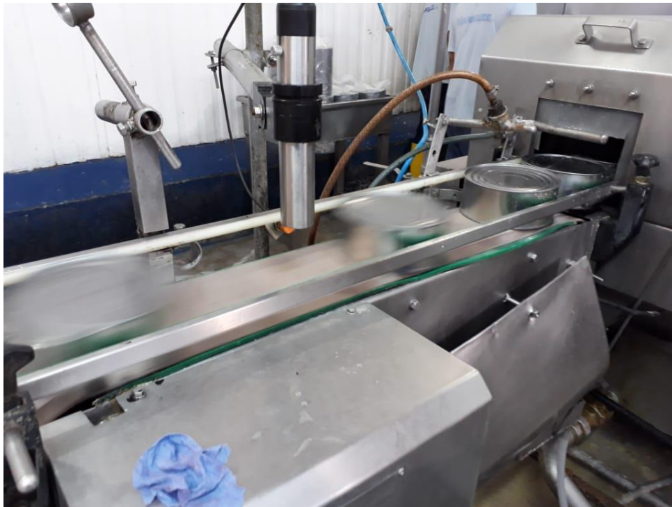
Figura 3-1: Cabezal de impresión ubicado después del lavado de latas.
