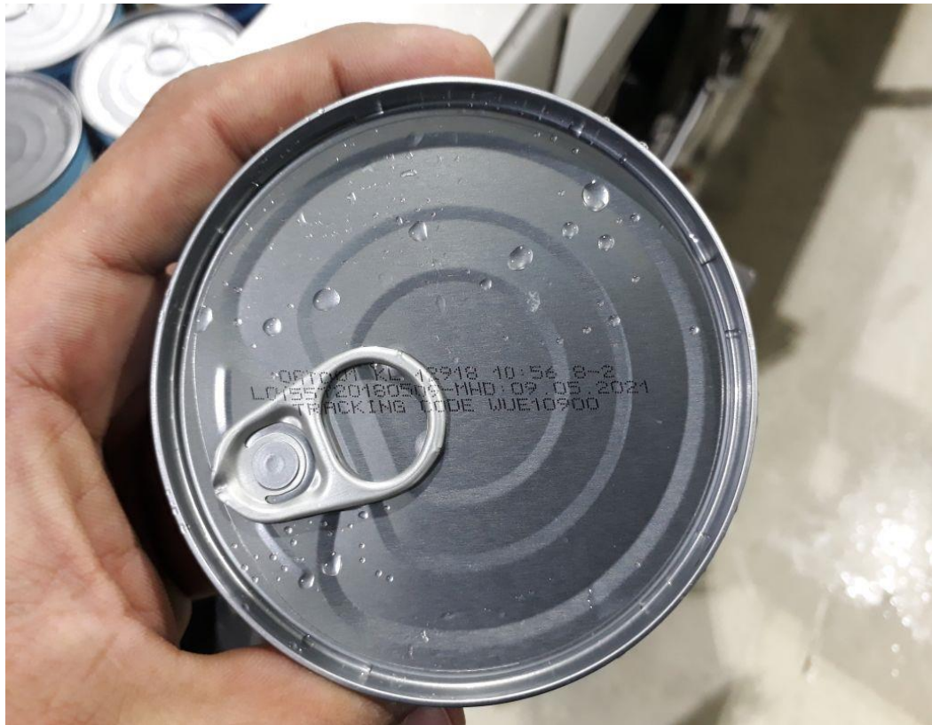
Figura 3-2: Lata después de codificado y cuenta con alto nivel de humedad.
