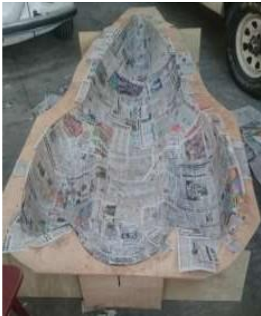
Figura 26-3: Molde inferior de madera cubierto con papel periódico y pegamento blanco
