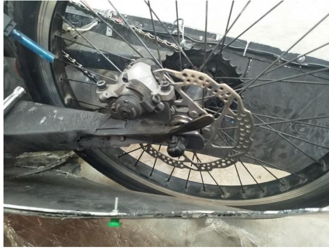
Figura 22-3: Implementación de frenos de disco, rueda posterior del prototipo
