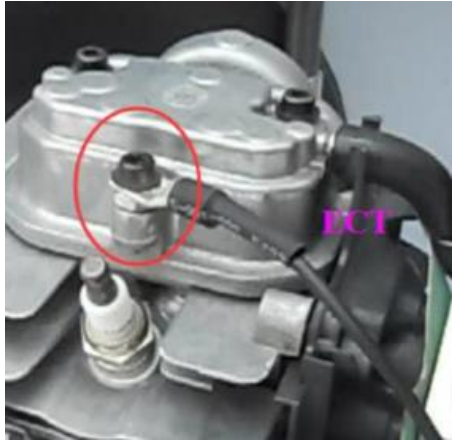
Figura 17-3: Instalación del sensor ECT
