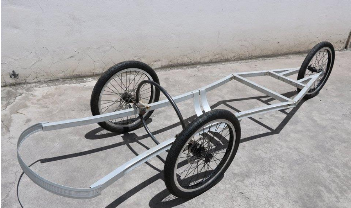
Figura 10-3: Fase inicial de construcción del bastidor
