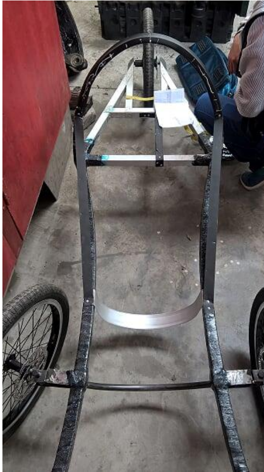
Figura 11-3: Bastidor reforzado con fibra de carbono
