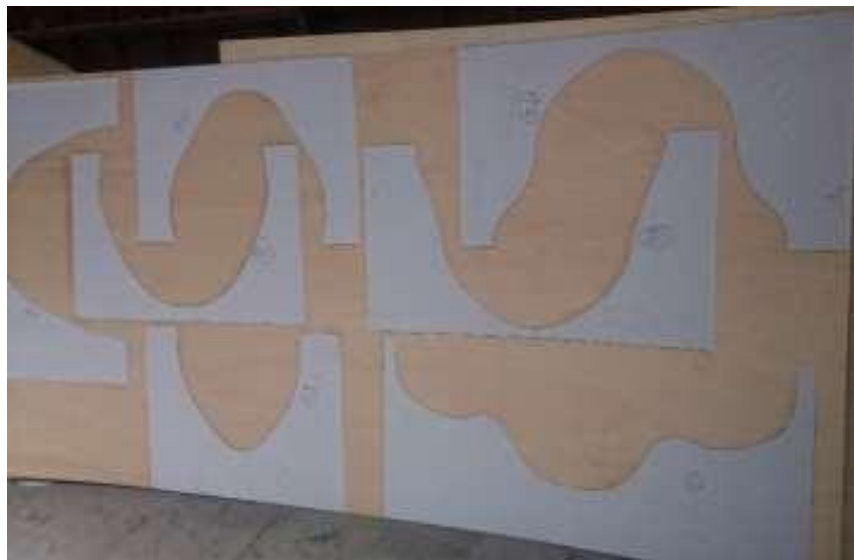
Figura 24-3: Realización de los cortes de sección transversal de madera para la base de la carrocería
