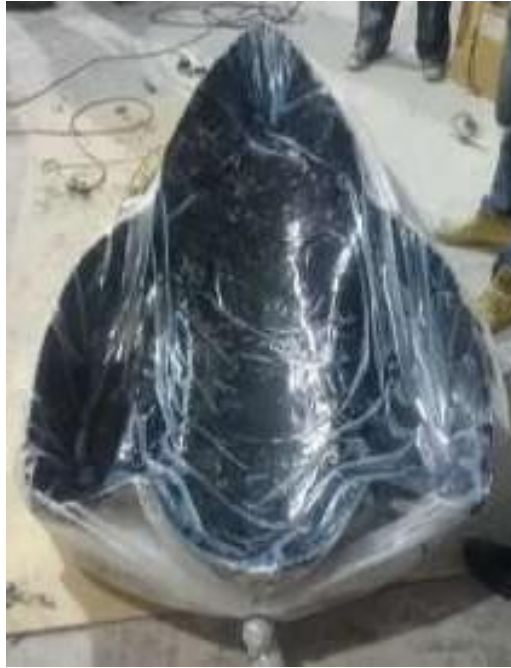
Figura 30-3: Capas de fibra de carbono sobre el molde de yeso
