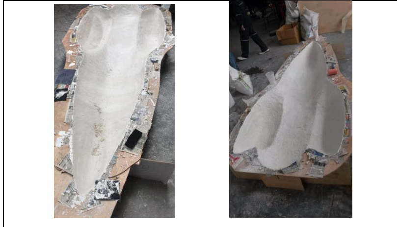
Figura 27-3: Capa de yeso para los moldes de la carrocería
