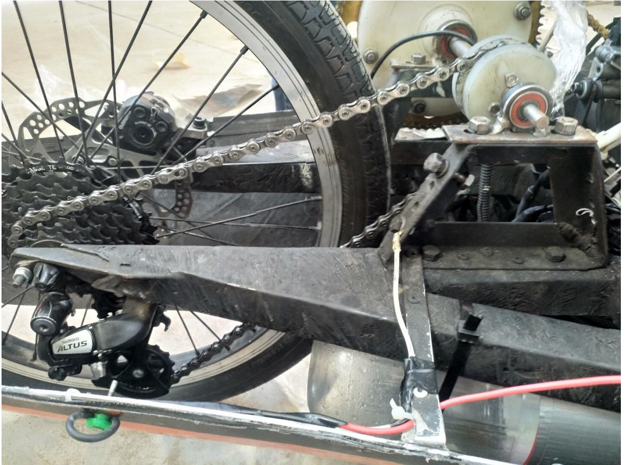
Figura 13-3: Segunda desmultiplicación del sistema de transmisión
