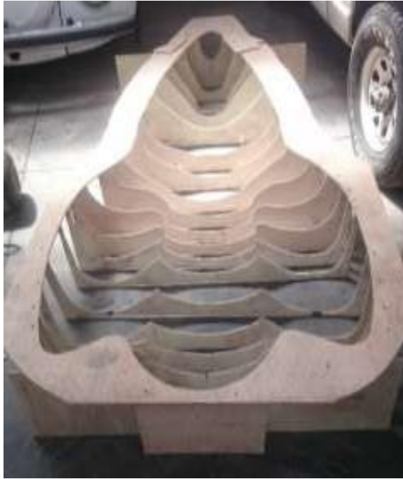
Figura 25-3: Molde inferior de madera con la silueta de la carrocería
