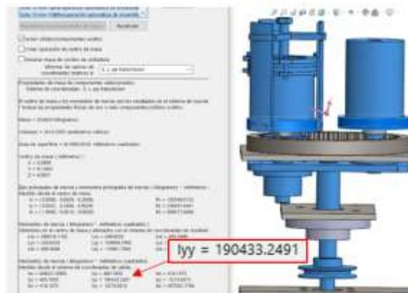
**Figura 22-4:** Momento de inercia con respecto al centro del eje de transmisión
