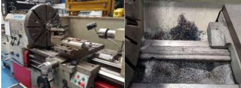
**Figura 9-2:** Procesos, máquinas y viruta del mecanizado de acero de transmisión
