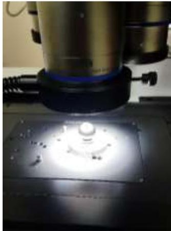
**Figura 10-5:** Bola de molienda en estereoscopio
