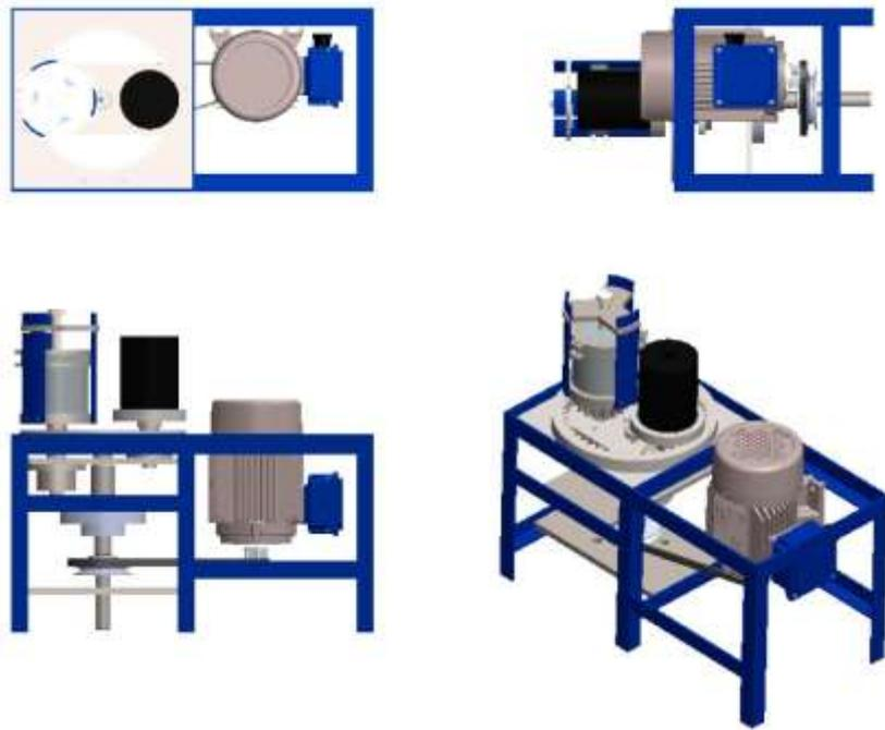
**Figura 10-3:** Elementos básicos de molino planetario.
