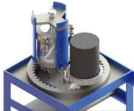
**Figura 56-4:** Configuración sistema de molienda y contrapeso
