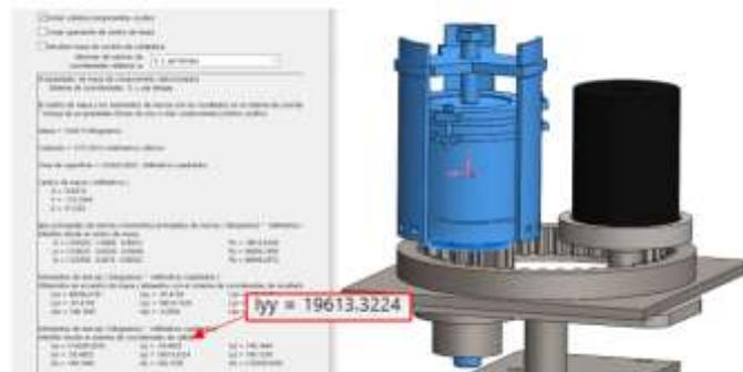
**Figura 21-4:** Momento de inercia del sistema de molienda con respecto a su eje
