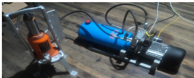
Figura 1-5: Pruebas preliminares de la central hidráulica
