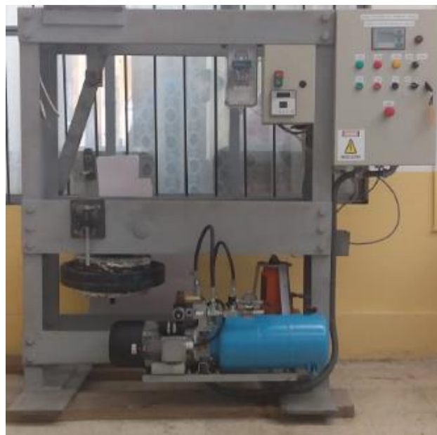
Figura 10-5: Instalación final del sistema hidráulico
