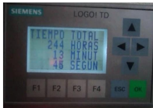
Figura 3-5: Tiempo de las pruebas de funcionamiento Realizado por: Lema, César; Montoya, Luis; 2018
