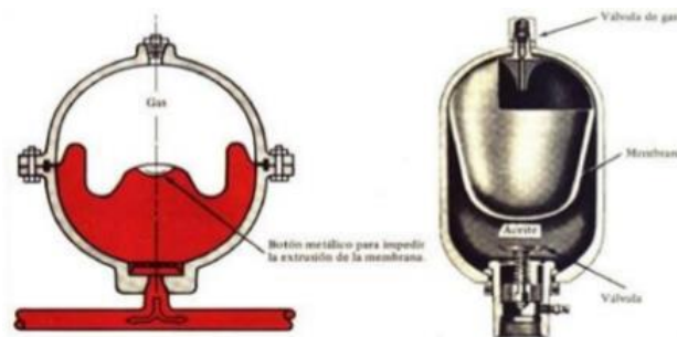
Figura 2-2: Sección de un acumulador de membrana
