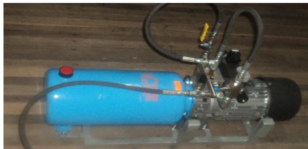
Figura 7-5: Montaje del soporte a la central hidráulica
