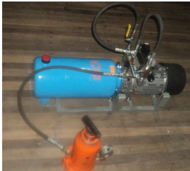
Figura 10-4: Adaptación del sistema hidráulico con el gato hidráulico
