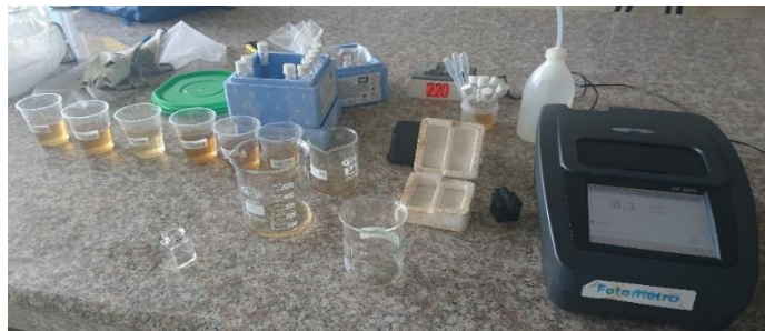
Fotografía 32-2. Medición de la concentración de nitratos en el fotómetro
