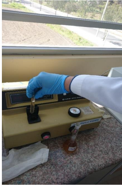
Fotografía 31-2. Medición de la absorbancia en el fotómetro
