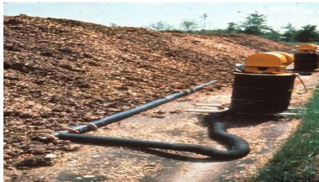
Figura 2-1. Pilas estáticas mediante aireación activa
