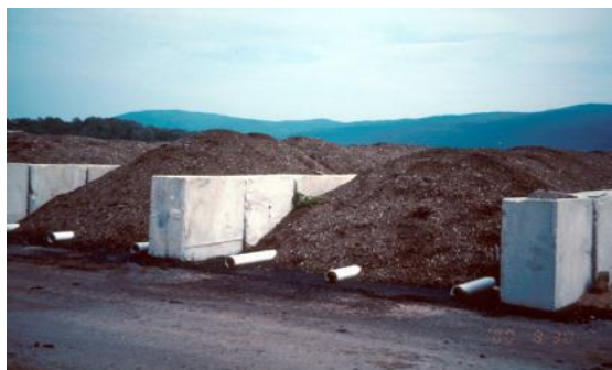
Figura 1-1. Pilas estáticas mediante aireación pasiva.
