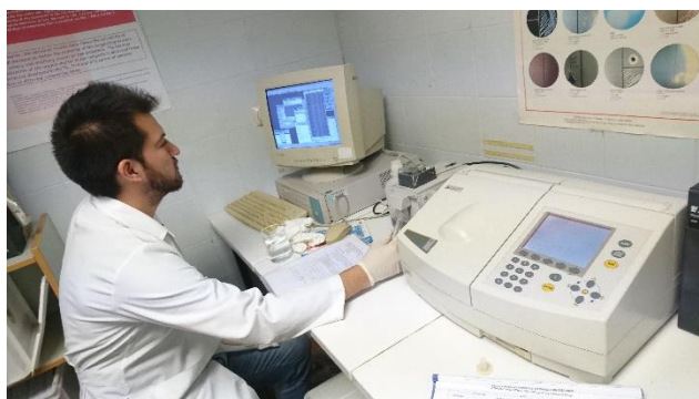
Fotografía 24-2. Medición de la absorbancia en espectrofotómetro
