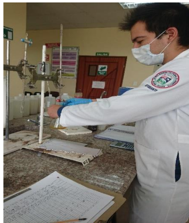
Fotografía 30-2. Titulación con nitrato de plata
