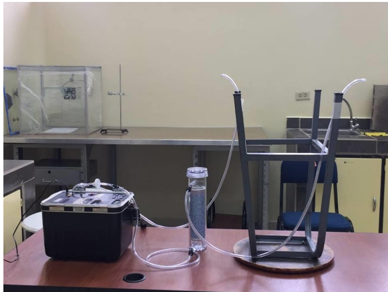
Figura 5-3: Configuración experimental para medir el fondo del Laboratorio de Técnicas Nucleares.
