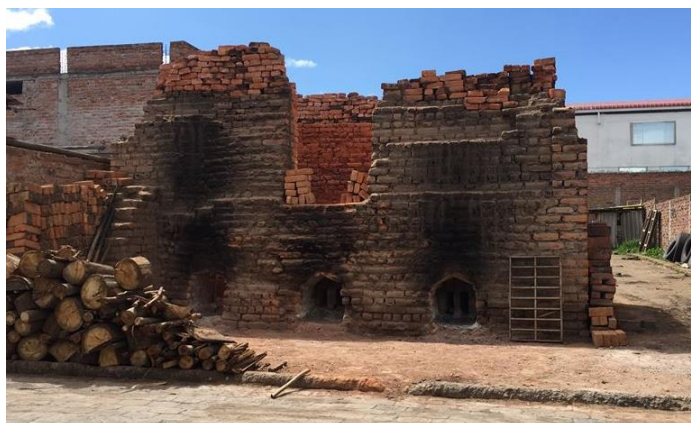
Figura 18-2: Horno donde se lleva el proceso de cocción de los adobes.
