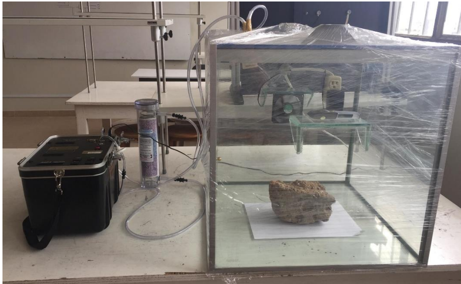
Figura 3-3: Configuración experimental del método de la cámara cerrada.
