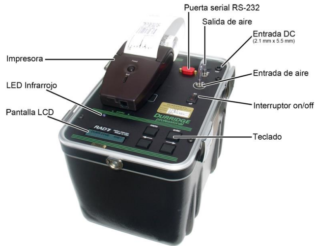
Figura 11-2: Partes externas del Detector RAD7. Realizado por: DURRIDGE Company, 2014.
