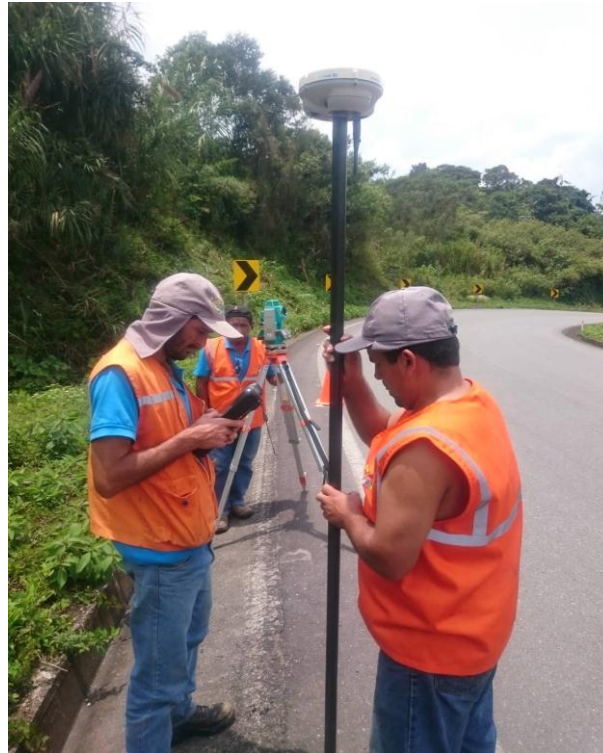
Figura No. 16: Marcación de coordenadas en el terreno.
