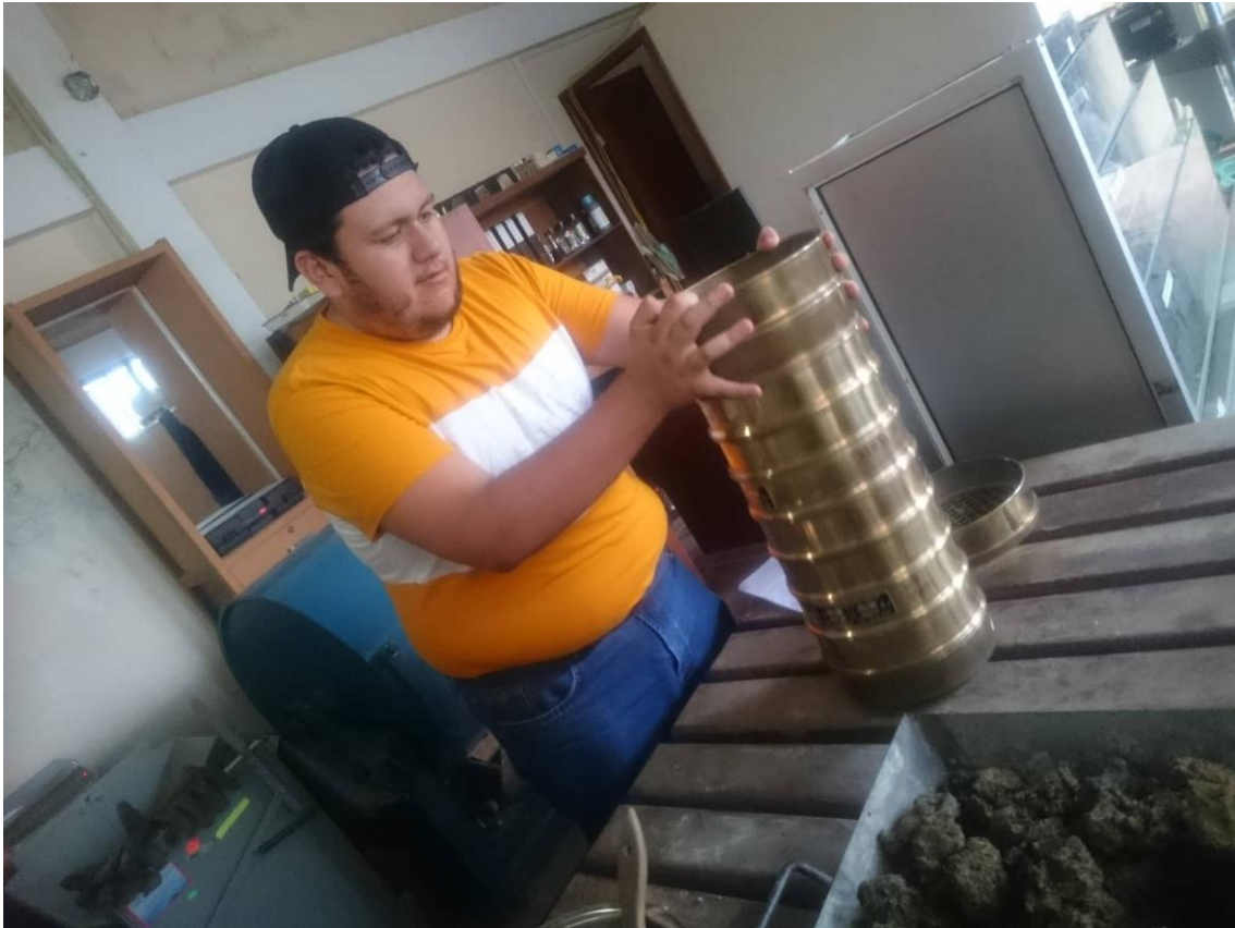
Figura No. 19: Procedimiento de tamizado para realizar la granulometría.
