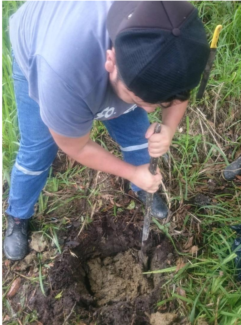
Figura No. 18: Realizando un agujero para obtener la muestra.
