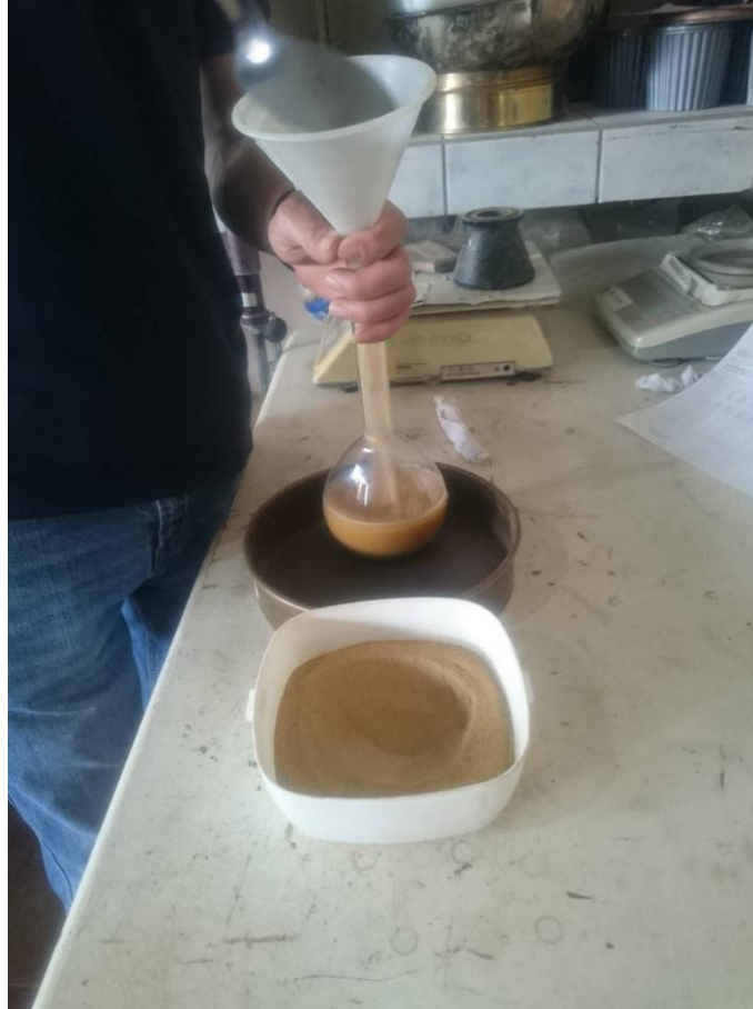
Figura No. 21: Procedimiento del ensayo de gravedad específica.
