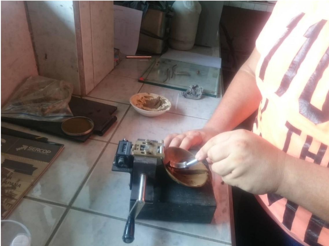
Figura No. 20 Procedimiento de limite liquido realizado en casa grande.
