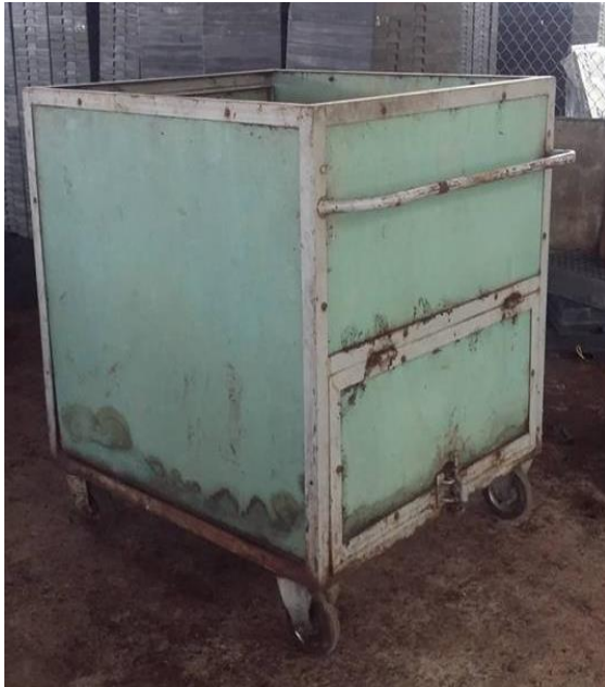
Ilustración 1. Cajón de sustrato de 1 m 3
