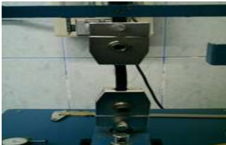
Fotografía 4. Colocación de la probeta de cuero entre las mordazas tensoras.
