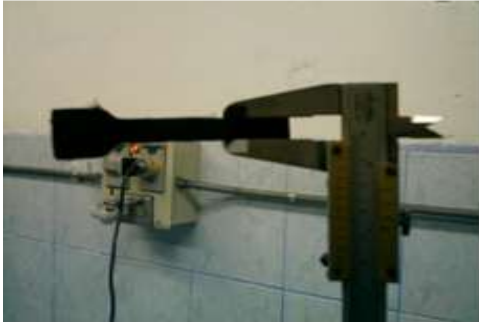
Fotografía 3. Medición de la longitud inicial del cuero.
