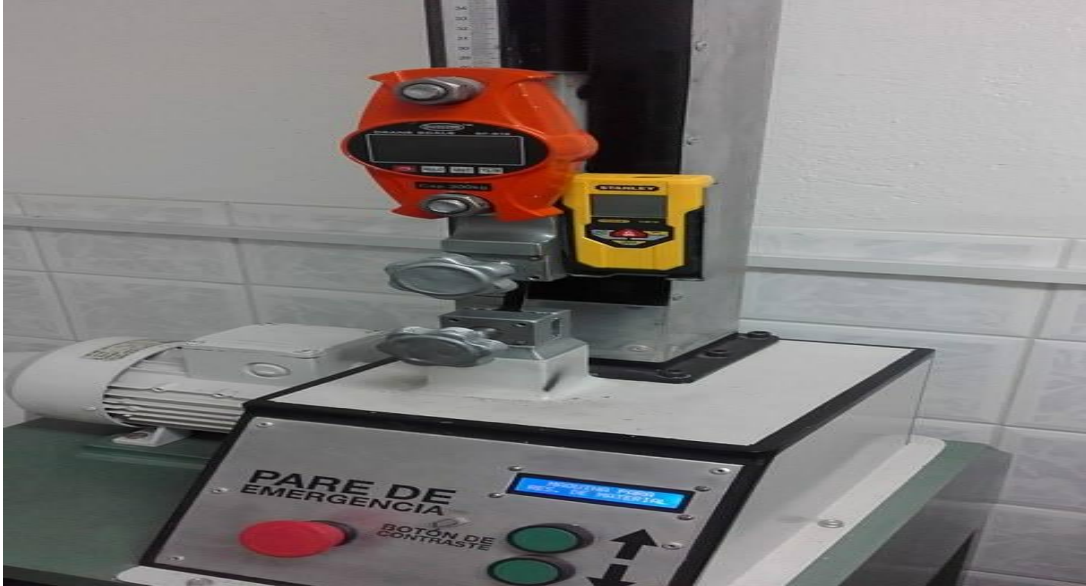
Fotografía 1. Partes de un equipo para realizar la medición de la resistencia a la tensión el cuero.
