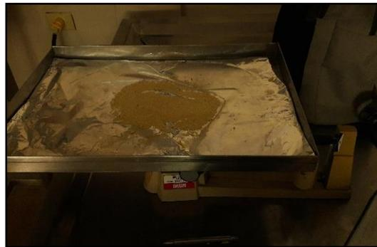
**Fotografía 12-3:** Pesaje del material seco
