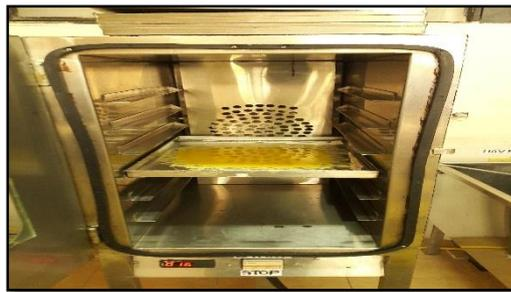
**Fotografía 11-3:** Secado del sedimentado total
