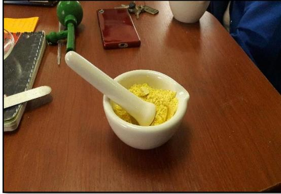
**Fotografía 13-3:** Molido del material sedimentado seco
