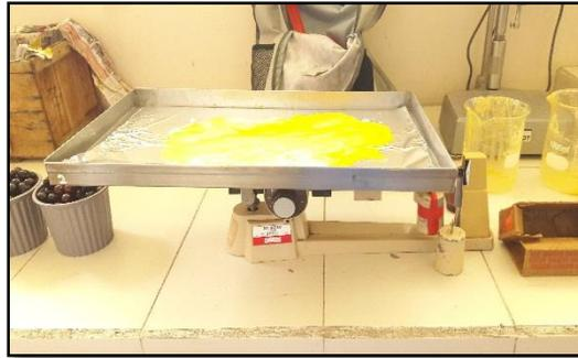
**Fotografía 10-3:** Pesaje del volumen total sedimentado
