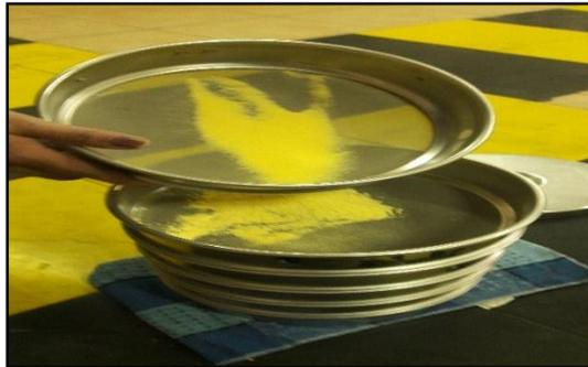
**Fotografía 14-3:** Tamizado del material molido
