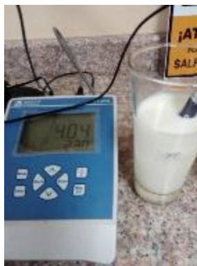
Fotografía 8-3: Medición de pH.
