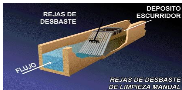
Figura 3-8 Rejillas de limpieza manual
