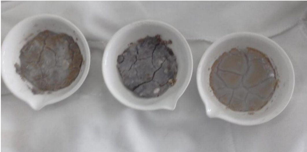
Figura 3-3: Fotocatalizadores de \text{TiO}_2/\text{Fe}_3\text{O}_4 (1, 5 y 10%) después de ser secado en estufa Realizado por: Urquizo; 2018
