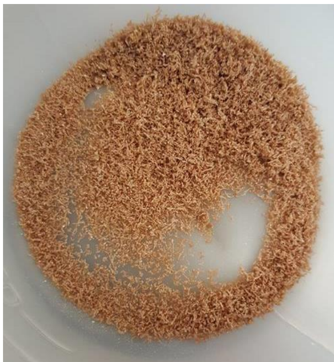
Figura 4-3: Fotocatalizador nanocomposito de \text{TiO}_2/\text{Fe}_3\text{O}_4 Realizado por: Urquizo; 2018
