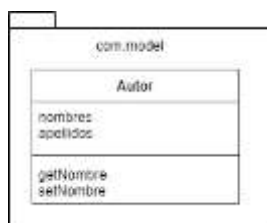
Figura 6-1: Ejemplo de la estructura paquete y clase Java. Realizado por: D. Fiallos, 2018.
