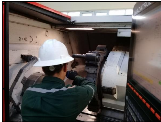
Figura 14-4. Cambio de herramientas de la torreta portaherramientas Fuente: Planta de Mecanizado y Producción
