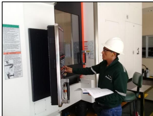
Figura 27-4. Programación de la pieza a mecanizar en MAZATROL Fuente: Planta de Mecanizado y Producción
