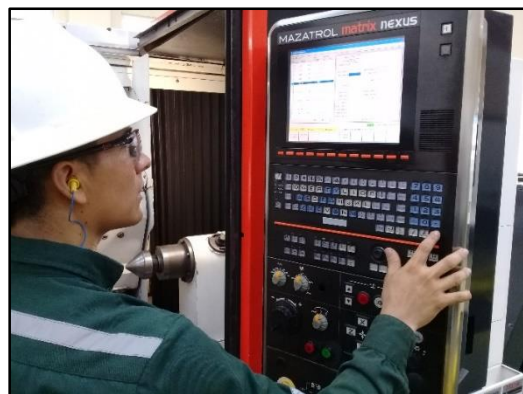
Figura 16-4. Programación de la pieza a mecanizar en MAZATROL Fuente: Planta de Mecanizado y Producción
