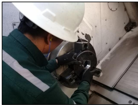
Figura 21-4. Desmontaje de la pieza mecanizada (Brida NPT 2") Fuente: Planta de Mecanizado y Producción
