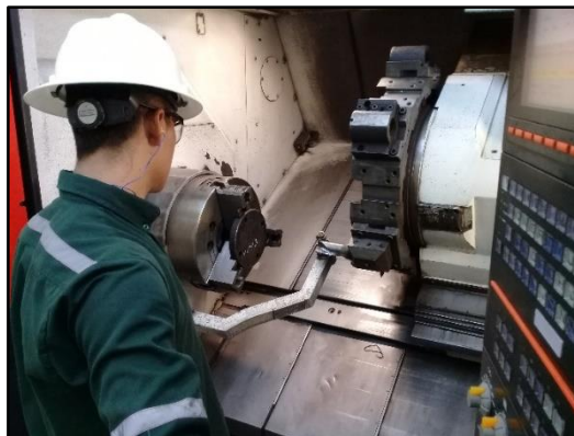
Figura 15-4. Sensado de herramientas mediante TOOL EYE Fuente: Planta de Mecanizado y Producción
