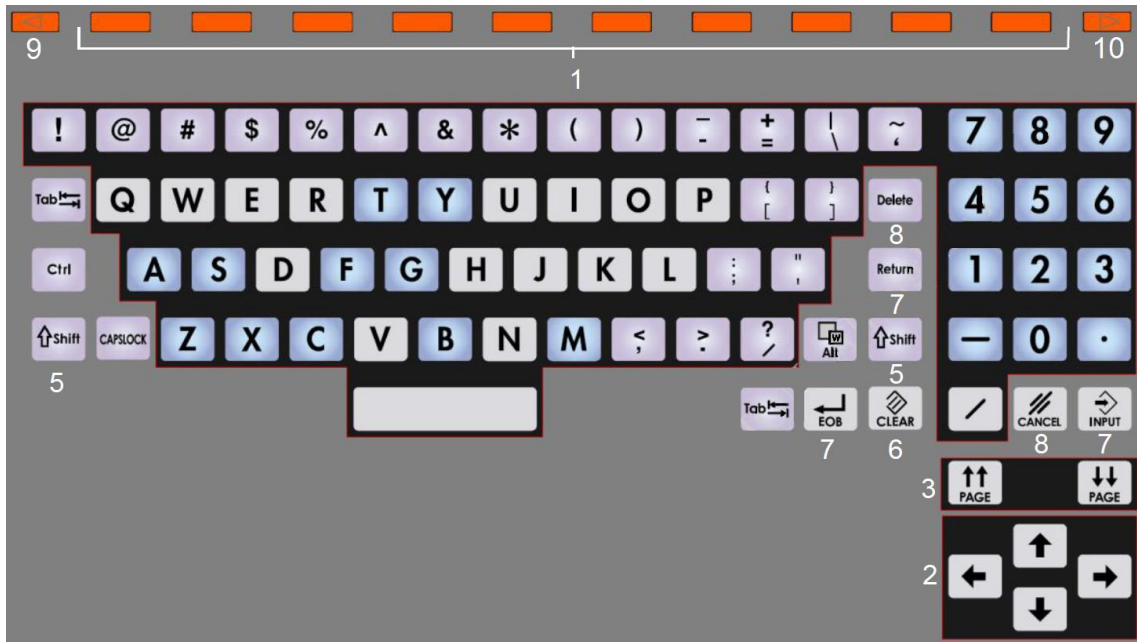
Figura 3-2. Teclas de configuración de datos Fuente: (MAZAK Corporation, 2014)
