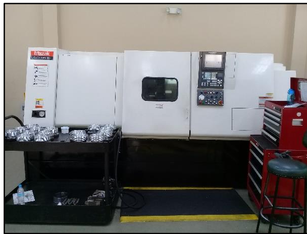
Figura 7-2. Torno QUICK TURN 350 Fuente: Planta de Mecanizado y Producción
