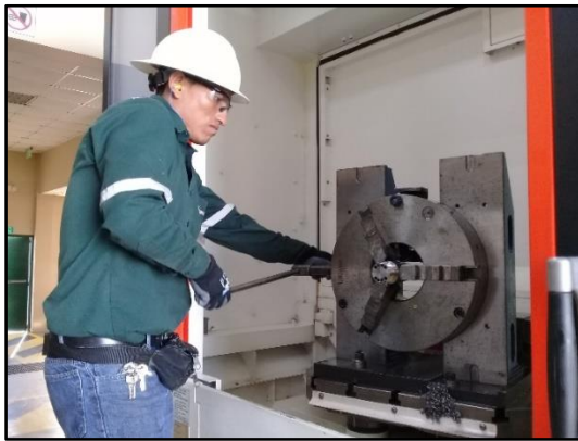
Figura 30-4. Desmontaje de la pieza mecanizada Fuente: Planta de Mecanizado y Producción
