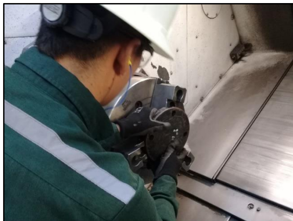
Figura 13-4. Montaje de la pieza de trabajo Fuente: Planta de Mecanizado y Producción
