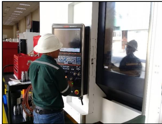
Figura 26-4. Sensado del cero de pieza mediante el sensor RENISHAW Fuente: Planta de Mecanizado y Producción
