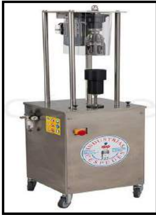
Figura 14-3: Taponador de botellas semiautomático para tapa rosca Fuente: Tomado de cotización de equipos ver anexo K
