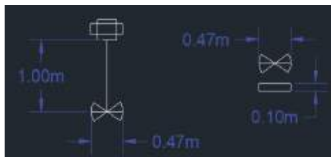
Figura 6-3. Longitud del brazo de agitación Realizado por: Javier Alba, 2018
