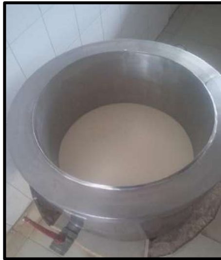
Foto 3-3 : Pasteurización de leche.
