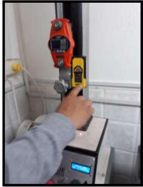
Prueba de resistencia a la tensión y % de elongación al cuero terminado
