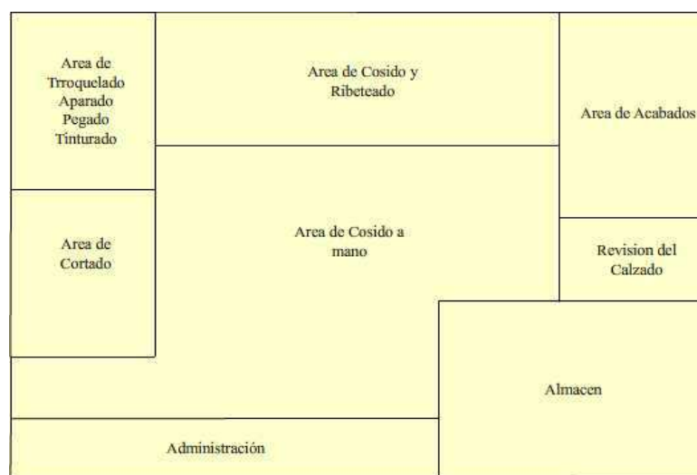
FIGURA No. 6 DISTRIBUCIÓN DE LA PLANTA
