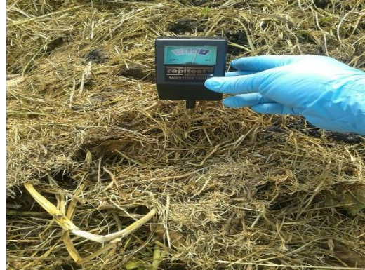
Fotografía 9-2 Medición de la humedad Realizado por: Alejandra Montaguano, 2018
