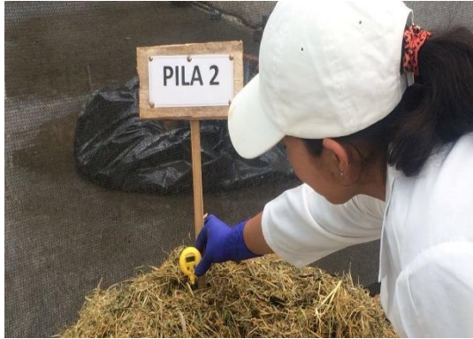
Fotografía 8-2 Medición de la temperatura Realizado por: Alejandra Montaguano, 2018
