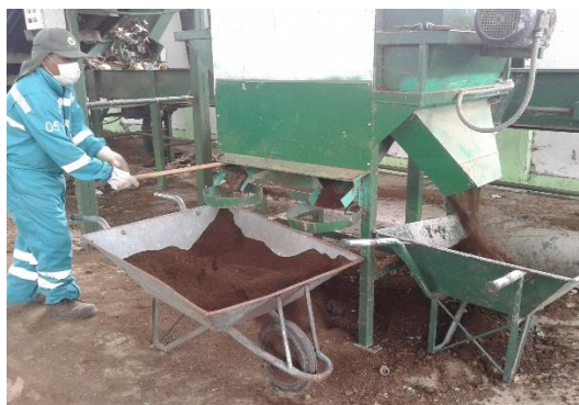
Fotografía 12-2 Cribado del compost Realizado por: Alejandra Montaguano, 2018
