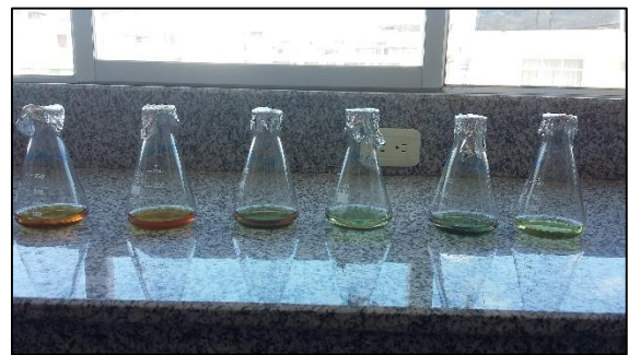
Fotografía 6C: Muestras después del proceso de adsorción a diferentes tiempos de contacto.
