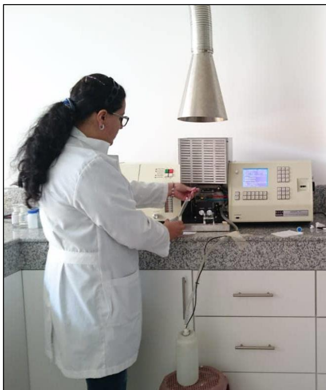
Fotografía 4-2: Determinación de cromo total por espectroscopia de absorción atómica
