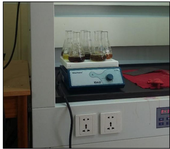
Fotografía 2C: Digestion acida de las muestras para determinación del pH óptimo
