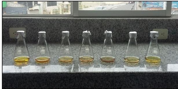
Fotografía 9C: Muestras a distintas concentraciones de cromo después del proceso de adsorción para el estudio de isotermas.
