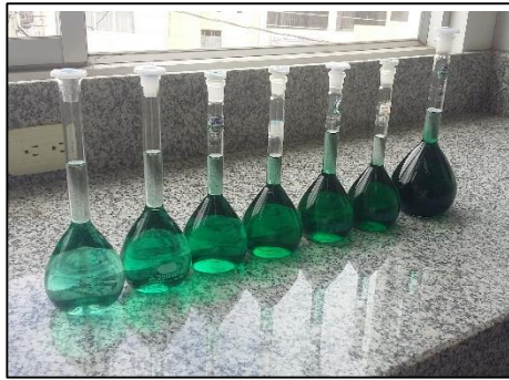
Fotografía 7C: Soluciones sintéticas de cromo a distintas concentraciones para el estudio de isotermas.
