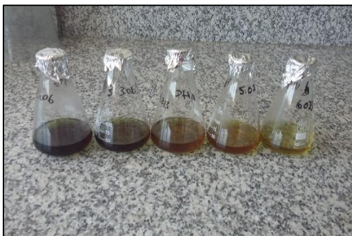
Fotografía 5C: Muestras después del proceso de adsorción con diferentes valores de pH.
