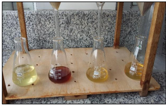
Fotografía 12A: Soluciones de cromo después del proceso de bioadsorción con las biomazas modificadas y sin modificar.
