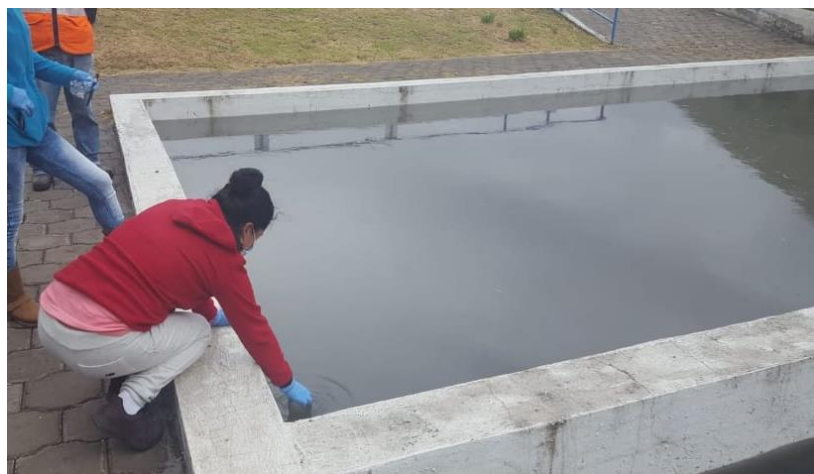
Figura 3-2: Toma de muestra en el Lecho de secado
