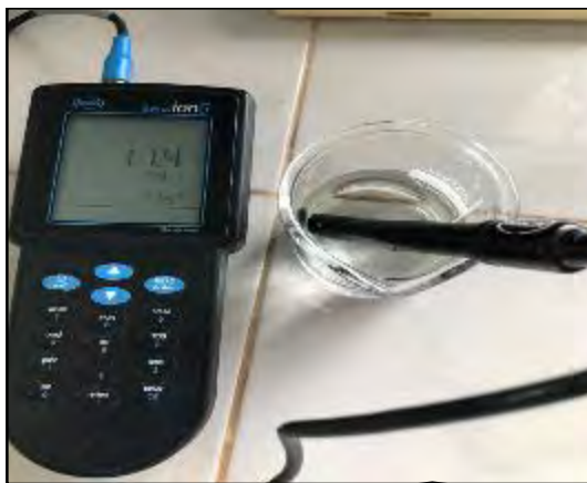
Conductímetro SENSION 5 (Análisis de Sólidos Totales Disueltos)
