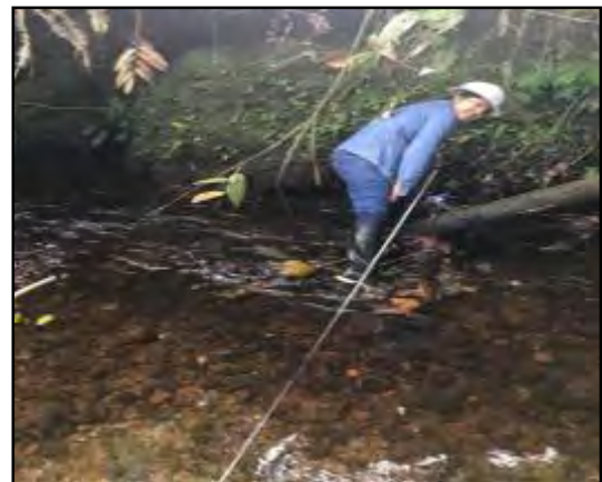
Medición del ancho de la sección transversal
