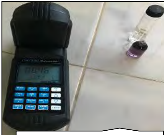
DR/890 Colorimeter (Análisis de Oxígeno Disuelto)
