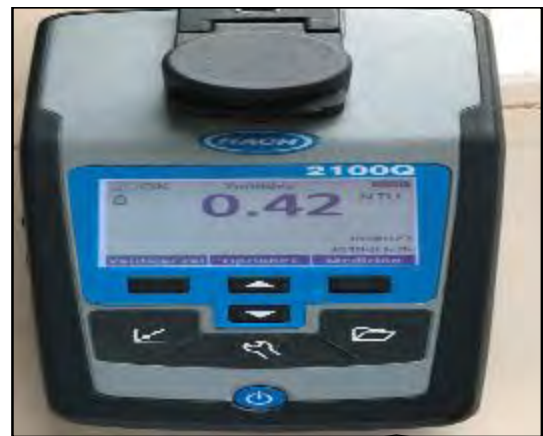
Turbidímetro 2100 Q (Análisis de Turbidez)
