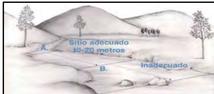
Figura 1-2: Selección del tramo para la medición.
