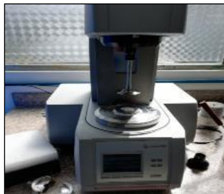
Fotografía 22-3: Medición de viscosidad en reómetro MCR 102.
