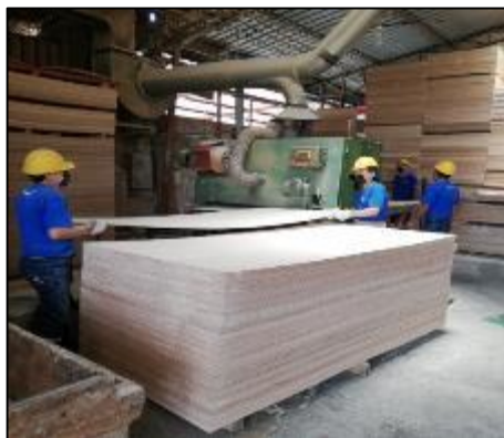
Fotografía 12-1: Escuadrado y lijado de tableros.
