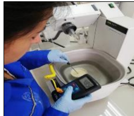
Fotografía 18-3: Medición de la temperatura para la curva exotérmica del adhesivo con 3F Uraform P4565.
