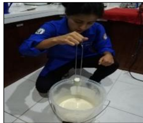
Fotografía 12-3: Medición de la viscosidad con la Copa Zahn #4.
