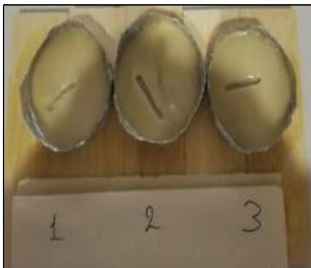
Fotografía 17-3: Muestras de tiempo de gel del adhesivo con 3F Uraform P4565.
