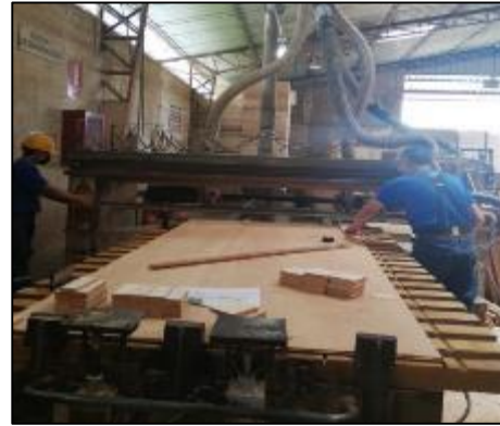
Fotografía 2-3: Corte de las muestras para ensayos de calidad.
