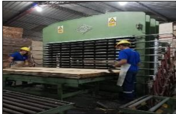
Fotografía 11-1: Prensado de tableros.
