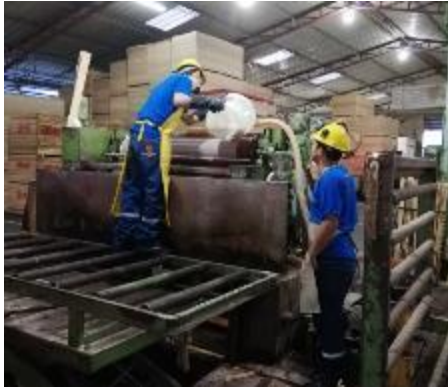
Fotografía 3-3: Aplicación del adhesivo de 1F en la encoladora.
