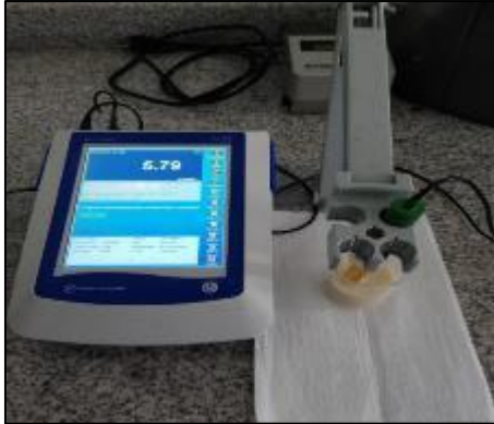
Fotografía 19-3: Medición de pH del adhesivo con resina CR-600.
