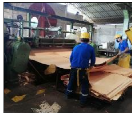
Fotografía 7-1: Desenrollo de chapas. Realizado por: Gabriela Miranda, 2019
