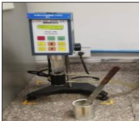
Fotografía 21-3: Medición de viscosidad en Viscosímetro Brookfield DV-II+PRO.
