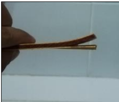
Fotografía 5-3: Pieza delaminada en el primer ciclo de la 1F T1.
