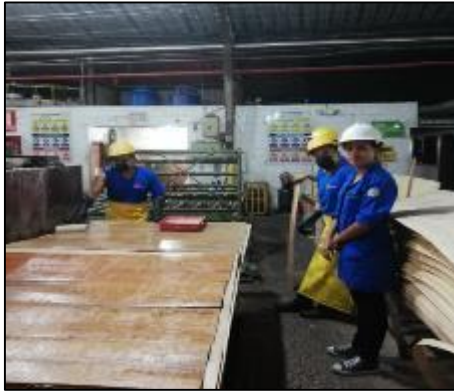
Fotografía 1-3: Aplicación manual del adhesivo con rodillo.
