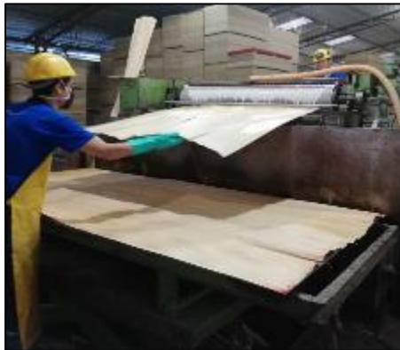
Fotografía 7-3: Aplicación del adhesivo de 2F en la encoladora.
