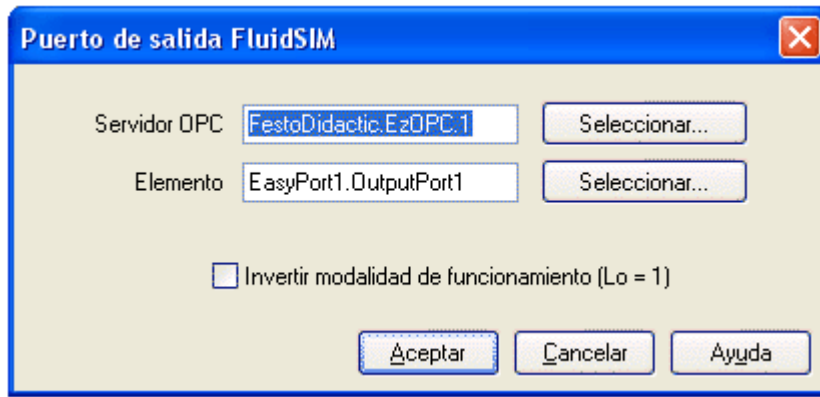
Figura 3-10 Configuración OPC Puerto de salida FluidSIM
