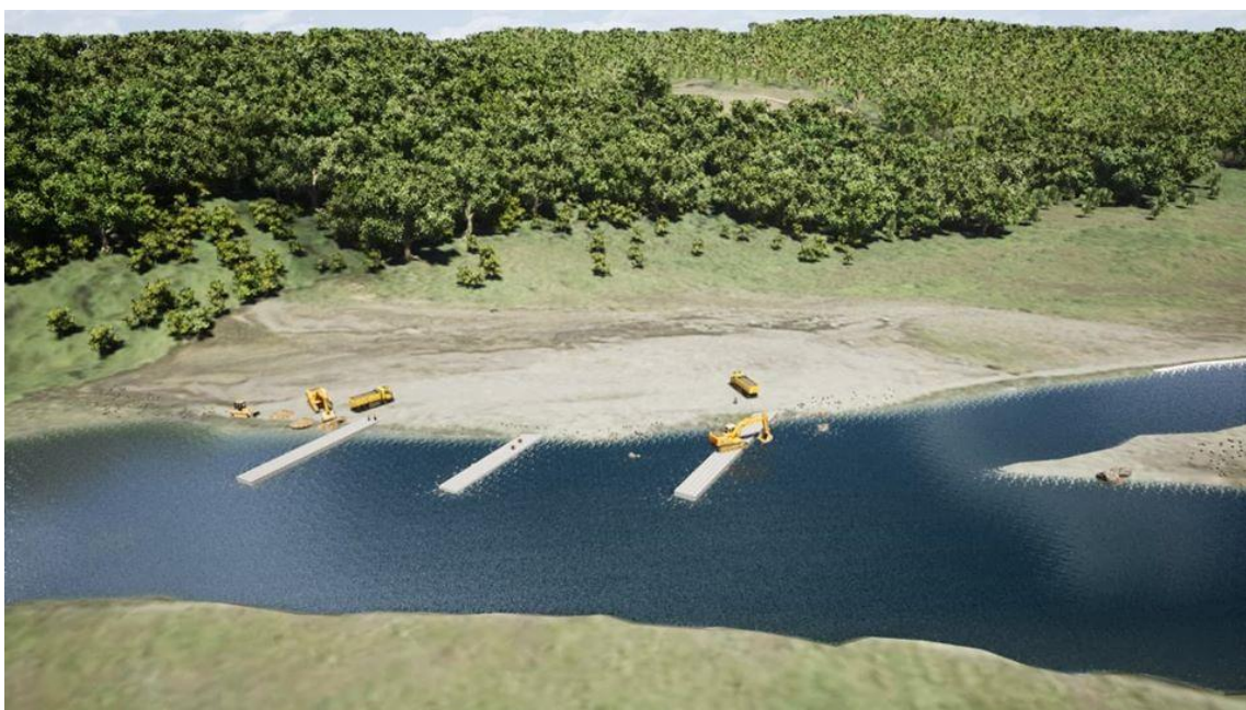
Anexo 28: Diseño 3D de los diques de la mina Tuntaime.
