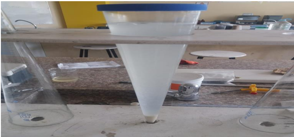
Fotografía 3-3: Proceso de sedimentación a escala de laboratorio
