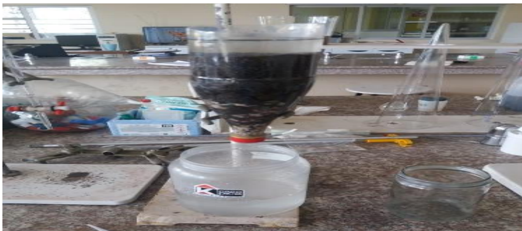
Fotografía 4-3: Proceso de filtración empleando un filtro de arena y grava a nivel de laboratorio Realizado por: JIMÉNEZ Víctor, 2018.
