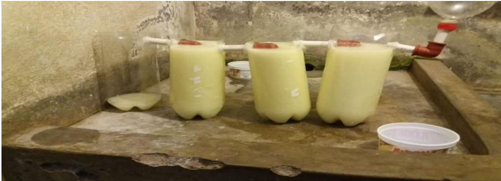
Fotografía 1-3: Trampa de Grasa a nivel de laboratorio
