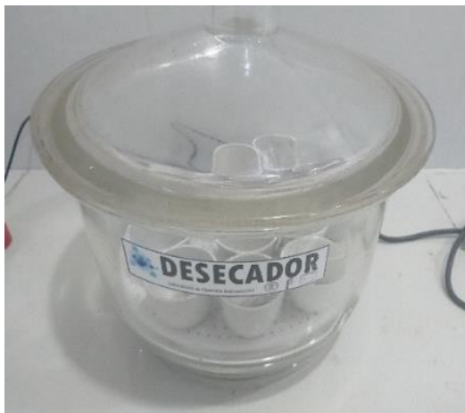
Ingreso de muestras al desecador despues de ser sometidos a 800° para cenizas
