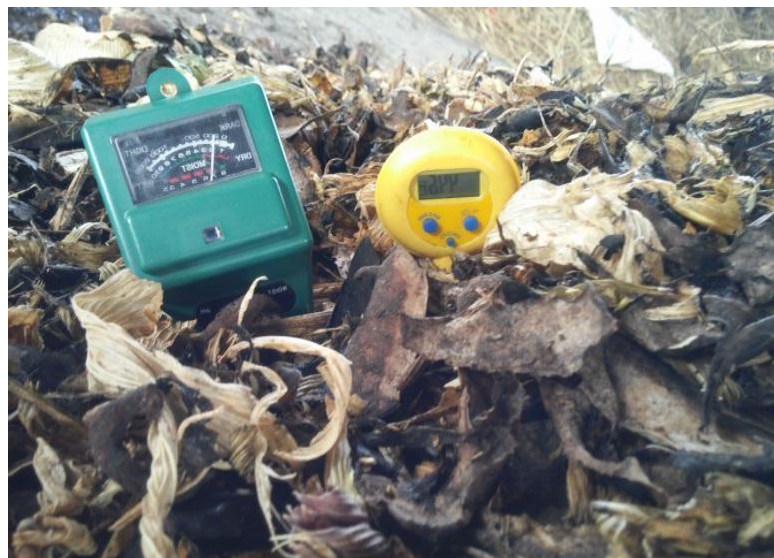
Figura 6-2: Control de pH, %H, T°. Realizado por: Mejía Estalin, Ramos Steven 2018.
