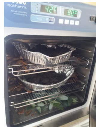
Secado de residuos en la estufa a 80°
