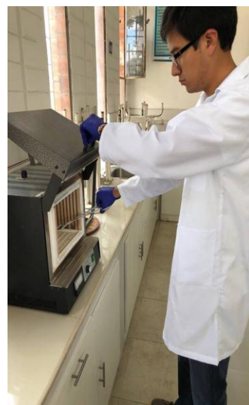
Tarado de crisoles a 500° para materia orgánica
