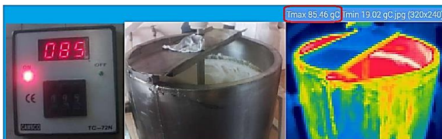
Figura 16-3: Prueba en mezcladora con doble pared Realizado por: Maldonado, L. 2018
