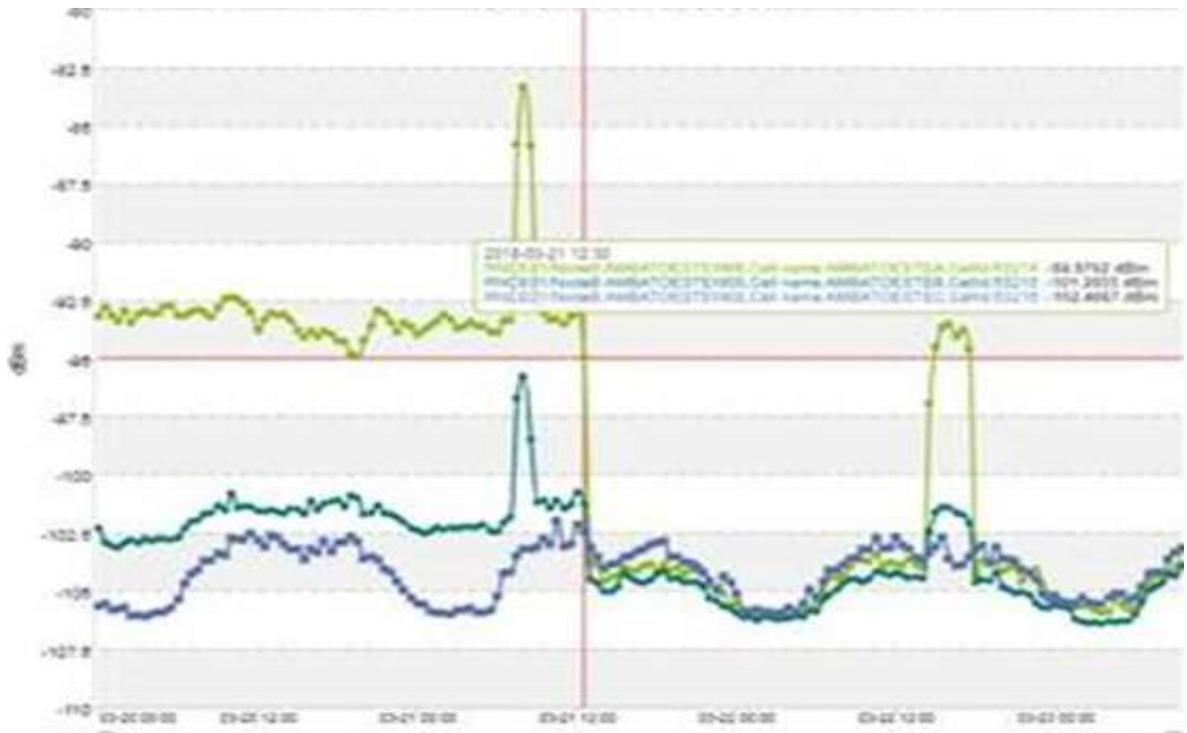
**Figura 18-3:** Interferencia dBm vs tiempo - BTS001 fecha 3
