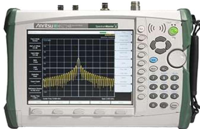
**Figura 5-2:** Analizador de espectro - ANRITSU modelo MS2724B
