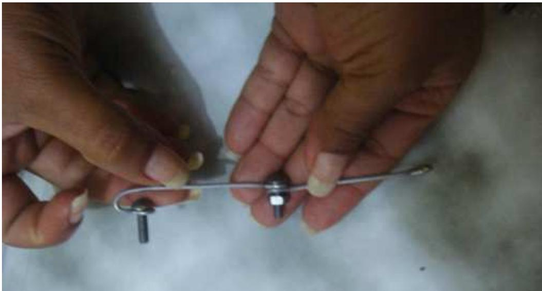
*Fotografía 8. Paso siete, unión de piezas para formar el brazo.*
