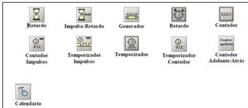
Figura 2-19: Elementos generadores de señal.
