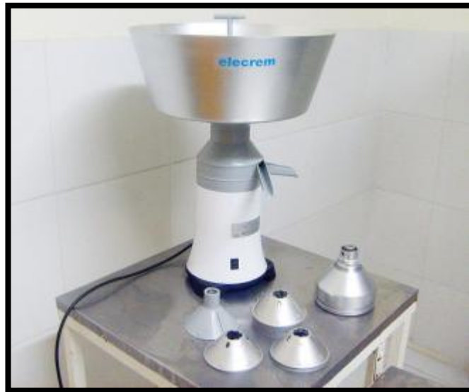
Figura 19.-Descremadora de acero inoxidable
