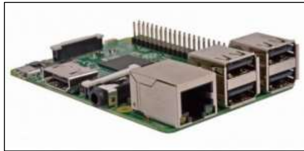
Figura 5-1: Raspberry Pi 3 Modelo B
