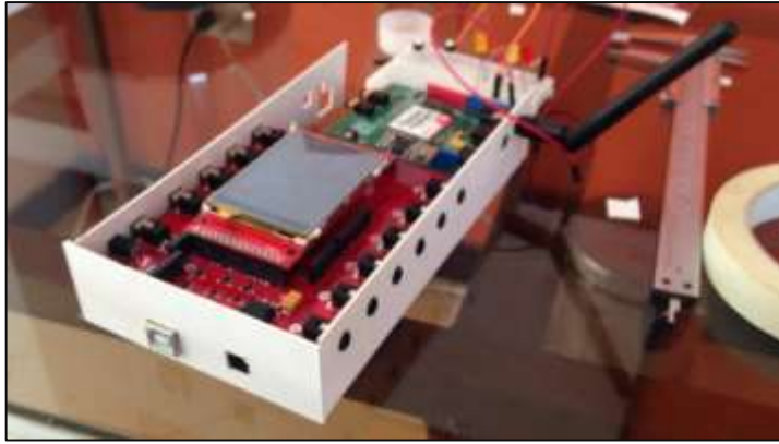
Figura 20-2: Construcción del “case”.
