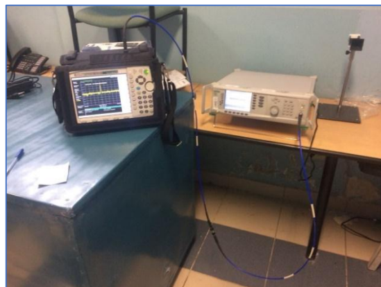
Figura 4-2 Medida de Potencia con dos Cables para Determinar la Pérdida del Mismo y sus Conectores.
