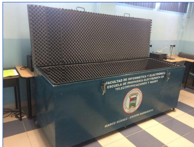
Figura 2-2 Implementación de la Cámara Anecoica
