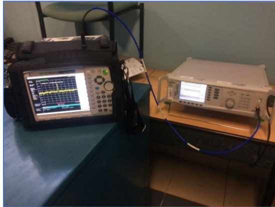
Figura 3-2 Medida de Potencia con un Cable para Determinar la Pérdida del Mismo.
