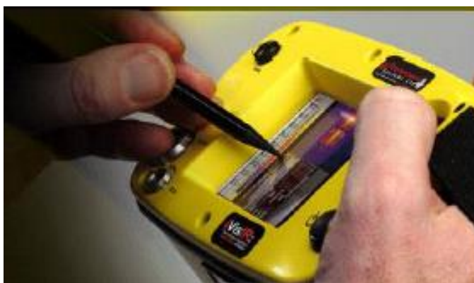
Figura 3.6: Pantalla de la Cámara VisIR Ti 200
