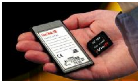
Figura 3.9: Almacenamiento de Datos de la Cámara VisIR Ti 200
