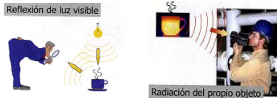
Figura 3.2: La Imagen Visual es Radiación Reflejada, la Infrarroja es Radiación Procedente del Propio Cuerpo
