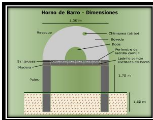
Grafico N°2 Estructura del Horno de Barro
