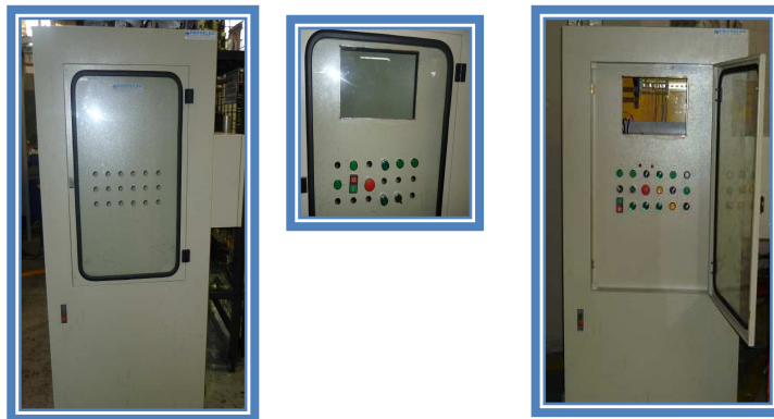
Figura 4.6. Orificios para la colocación de los elementos en el panel de control.
