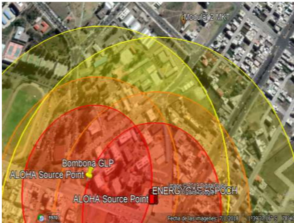
Figura 10-3: Zonas de afectación por explosión a la redonda Fuente: Google Earth Pro
