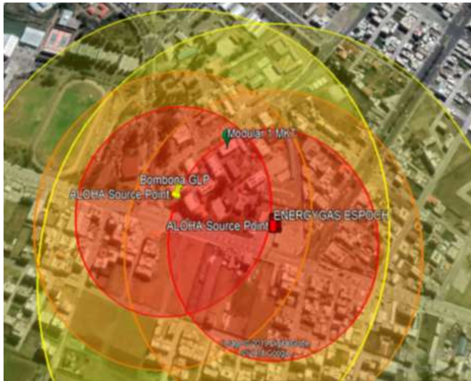
Figura 7-3: Zonas de afectación por explosión ENERGYGAS ESPOCH y GLP Fuente: Google Earth Pro
