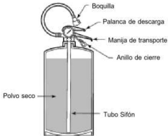
Figura 13-2: Parte de un extintor portátil PQS.
