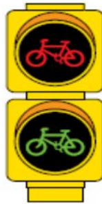
Figura 19. Semáforo para bicicletas Fuente: Reglamento Técnico Ecuatoriano RTE INEN 004 Señalización vial. Parte 6.
