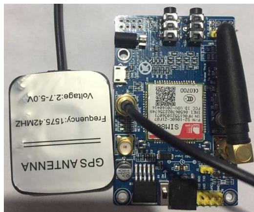
**Figura 2-3:** Instalación de la antena GPS
