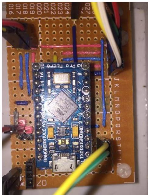
**Figura 7-3:** Instalación Arduino Pro micro
