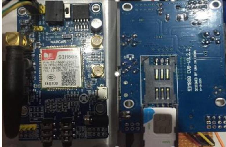
**Figura 1-3:** Instalación del módulo SIM808
