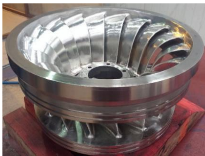
Figura 2-4: Rodete Francis de la Central Hidroeléctrica Lumbaqui.
