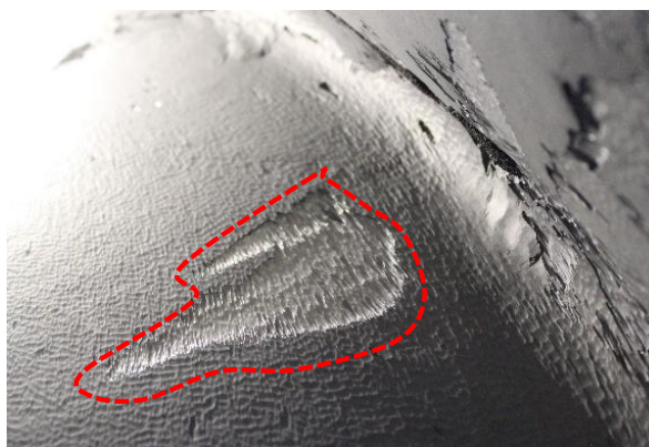
Figura 4-1: (1) Corte por erosión y (2) erosión por cavitación
