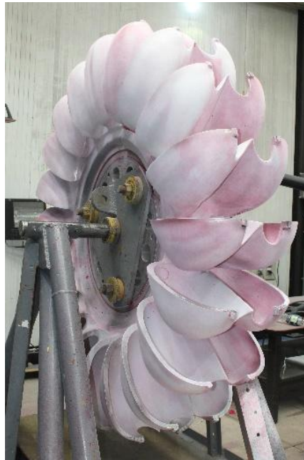
Figura 2-49: Ensayo de tintas penetrantes rodete Pelton.
