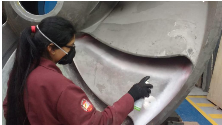
Figura 3-9: Ensayo de tintas penetrantes en junta soldada.
