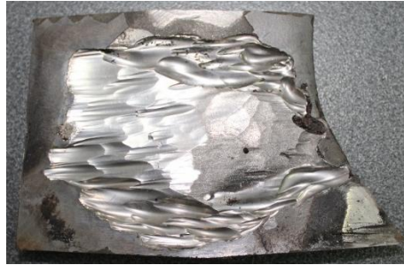
Figura 4-2: Zona desgastada del Rodete Francis de la CHSF.
