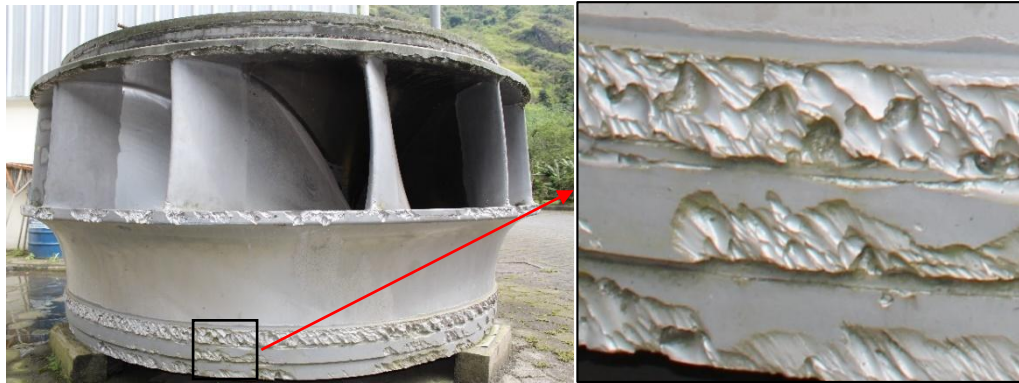
Figura 2-10: Superficie erosionada del Rodete Francis de la U1 de la CHSF.
