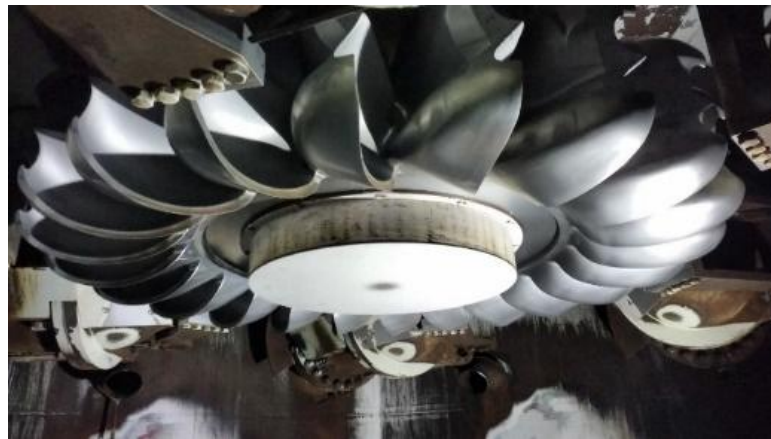
Figura 2-3: Rodete Pelton de la Central Hidroeléctrica Coca Codo Sinclair.
