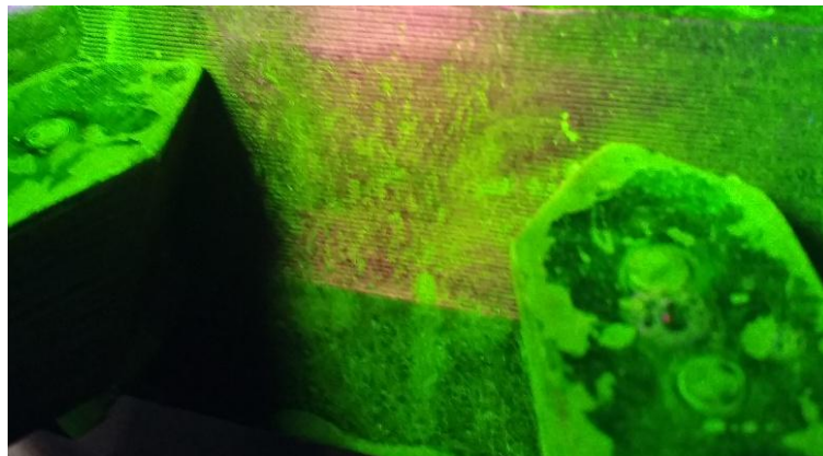
Figura 3-10: Ensayo de partículas magnéticas en junta soldada.
