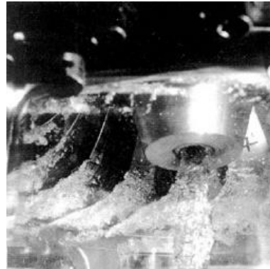
Figura 2-14: Cavitación fija (movimiento de burbujas en un rodete Francis).
