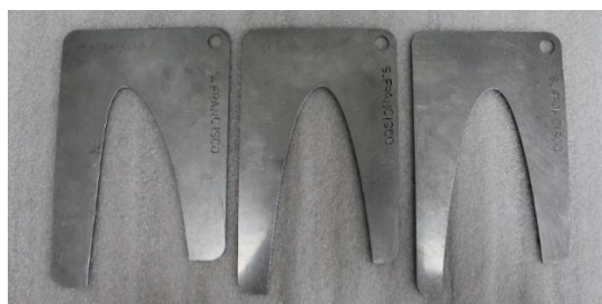
Figura 2-43: Plantillas de control de perfil para rodete Francis.
