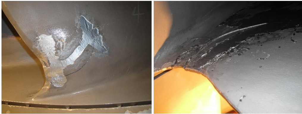
Figura 3-1: Fisura álabe #04 U2
