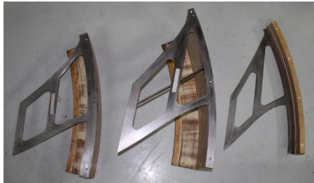
Figura 2-45: Plantillas de control de perfil para rodete Francis.
