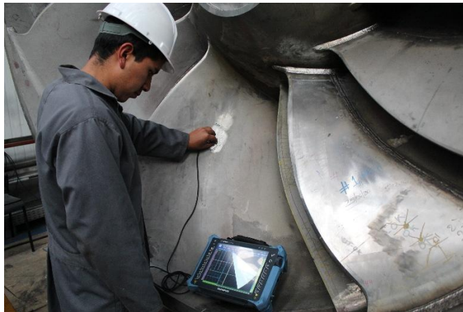
Figura 3-11: Ensayo de ultrasonido en junta soldada.
