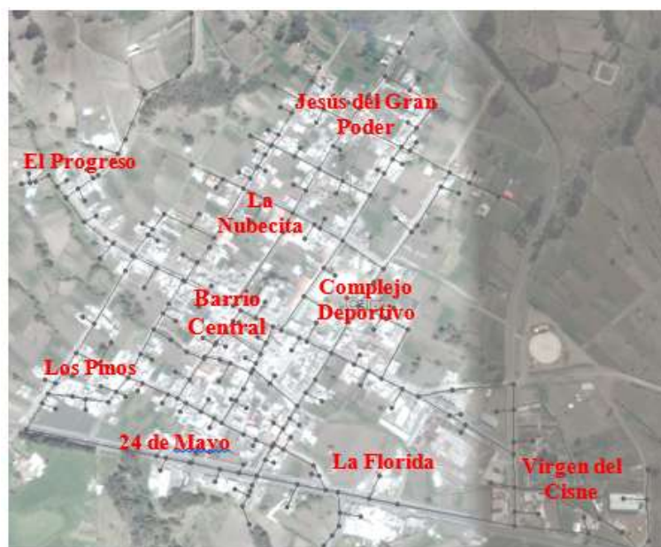
Figura 22-3: Esquema de la red de distribución en los barrios. Realizado por: Fiallos Avila Karen Lizbeth, 2019.
