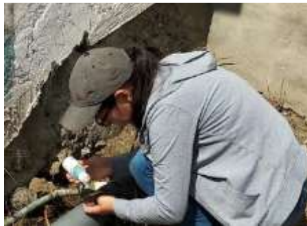
Figura 32-3: Medición de caudal a la entrada de los depósitos. Realizado por: Fiallos Avila Karen Lizbeth, 2019.
