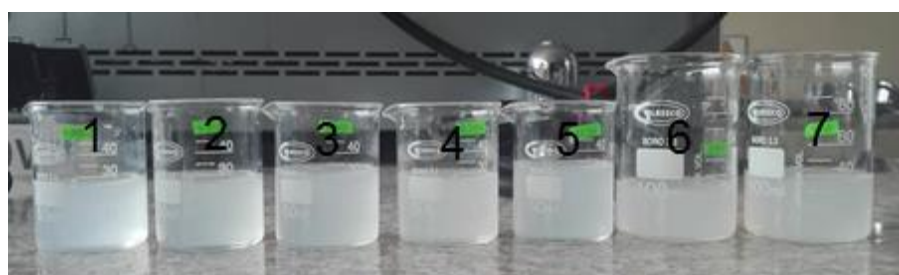
Figura 14-2: Variación de pH nanorefrigerante 15% Propylg. 0,2% NPs. A.
