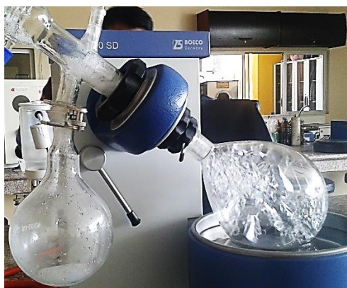
Figura 25-3: Generación de burbujas (15% Propilg, 0,5% NPs A y 1% SDS).
