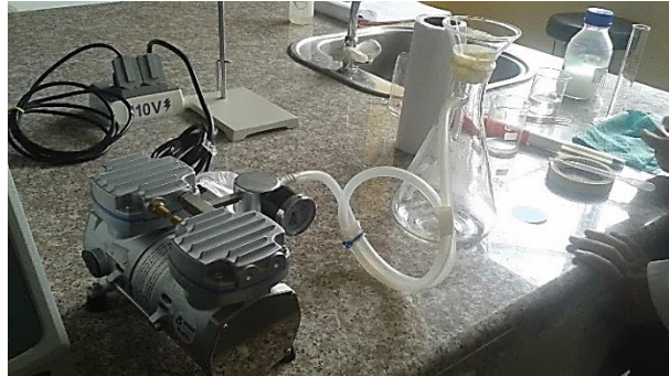
Figura 18-2: Instalación de equipos y materiales prueba Nanofiltración.
