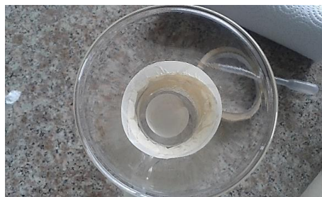
Figura 19-2: Obstrucción de nanorefrigerante en la membrana.
