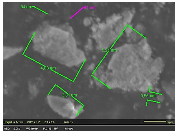
Figura 33-3: NPs recuperadas por centrifugación con posible presencia de SDS a x8000 de aumento.
