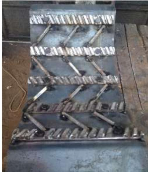
**Figura 19-4:** Barras de corte en el cóncavo
