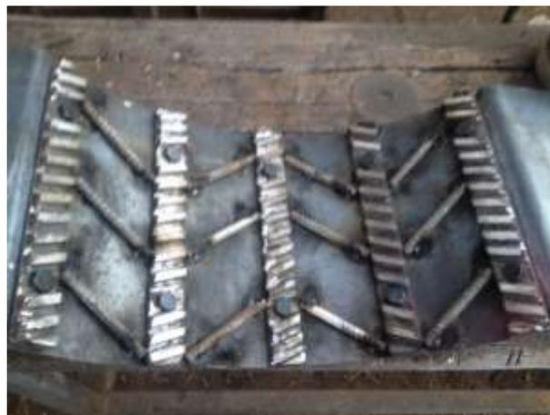
**Figura 18-4:** Diseño del cóncavo
