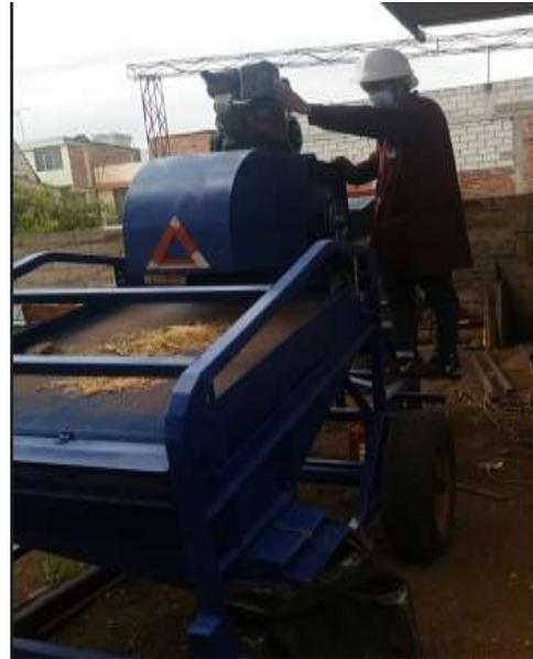
**Figura 26-4:** Sistema de trillado de quinua
