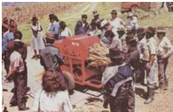
**Figura 18-2:** Trilladora estacionaria
