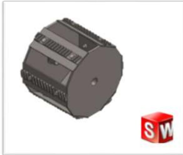
**Figura 7-4:** Cilindro Trillador
