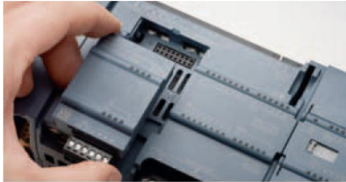
Figura 10-2 Signal board del PLC S7 1200. Fuente:(Mayorga et al. 2012)
