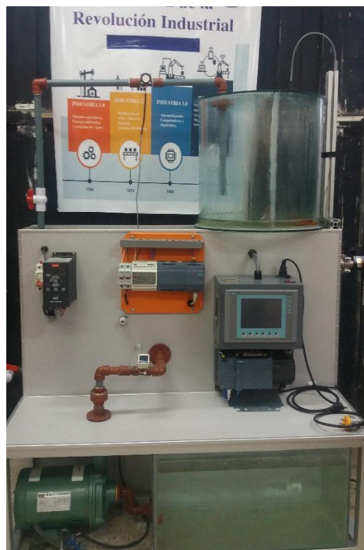
Figura. 13-3: Disposición de equipos en el módulo.
