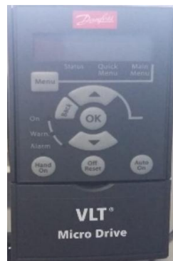
Figura. 10-3: Variador de frecuencia VLT. Fuente: (Autores)
