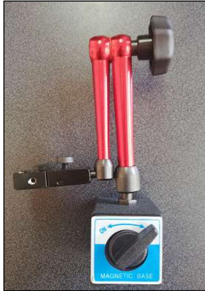
Figura 19-3: Soporte de base magnética. Fuente: (Autores, 2019)
