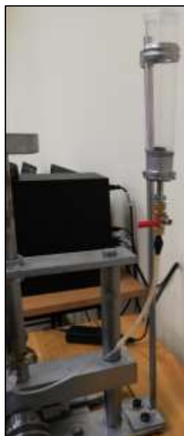
Figura 49-3: Sistema de lubricación por gravedad. Fuente: (Autores, 2019)
