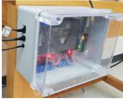
Figura 25-3: Carcasa del módulo de automatización. Fuente: (Autores, 2019)
