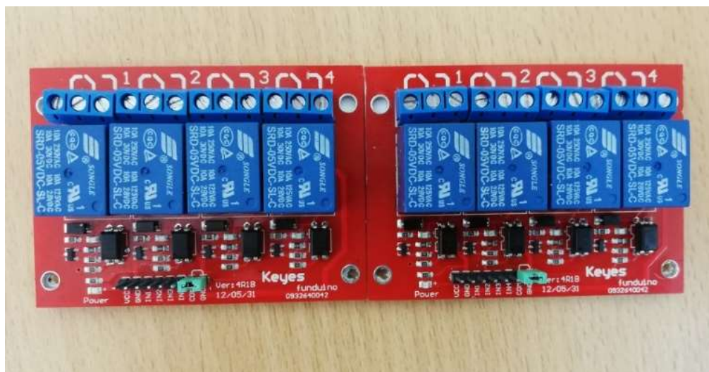
Figura 16-3: Módulo de relés MD-278. Fuente: (Autores, 2019)
