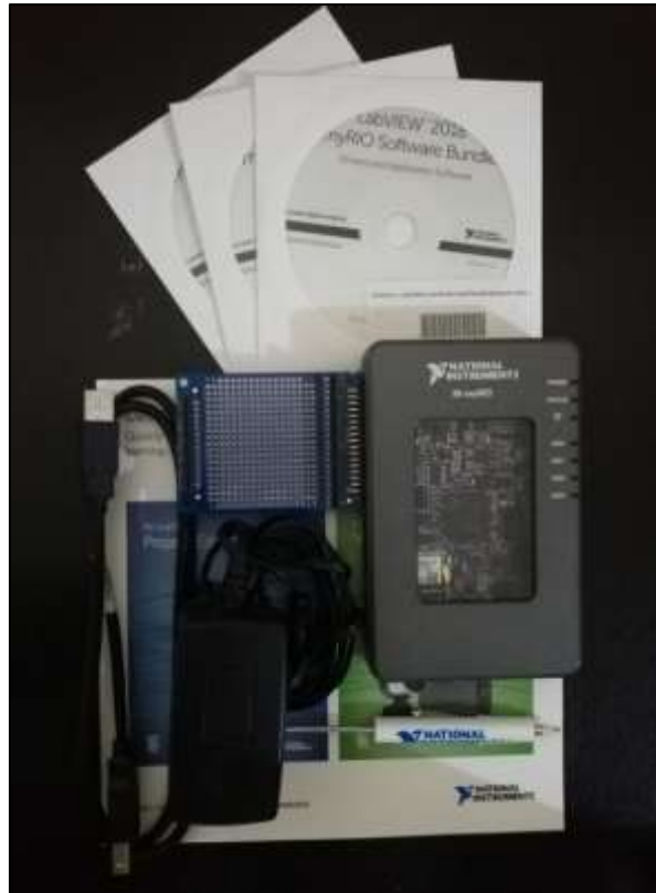
Figura 12-3: Tarjeta NI myRIO 1900. Fuente: (Autores, 2019).
