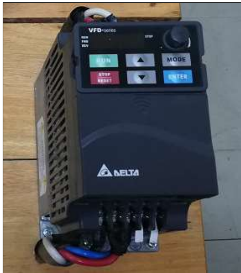
Figura 20-3: Variador de frecuencia Delta VFD007E23A. Fuente: (Autores, 2019)
