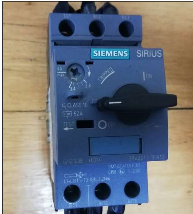
Figura 22-3: Interruptor automático siemens Sirius 3RV2011-1EA1. Fuente: (Autores, 2019)
