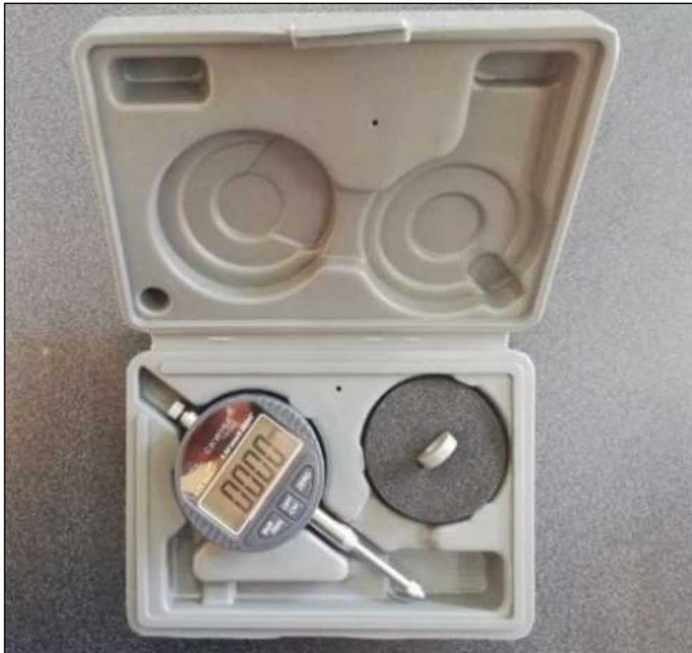
Figura 18-3: Reloj comparador digital DIGR-0105. Fuente: (Autores, 2019)
