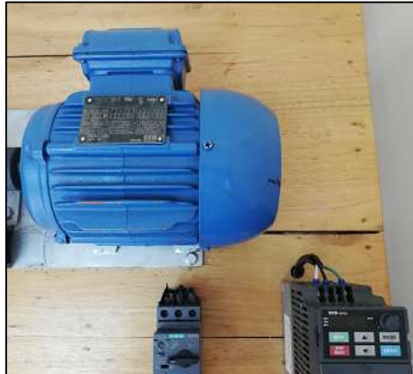
Figura 3-3: Carencia de instalación eléctrica a tierra. Fuente: (Autores, 2019).
