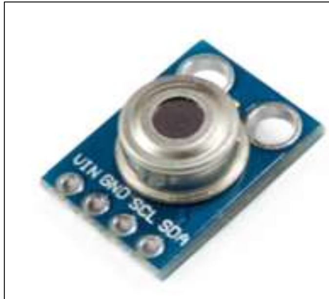
Figura 15-2: Termómetro infrarrojo a distancia MLX90614. Fuente: (LLAMAS, 2016)
