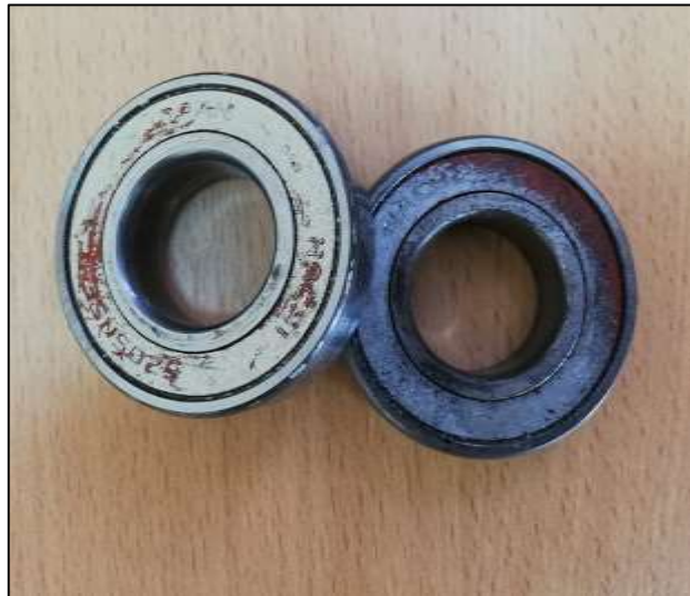
Figura 6-3: Rodamientos 6205 en mal estado. Fuente: (Autores, 2019).
