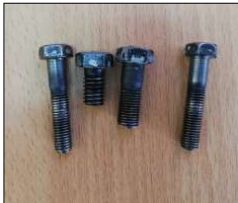
Figura 5-3: Pernos en mal estado. Fuente: (Autores, 2019).
