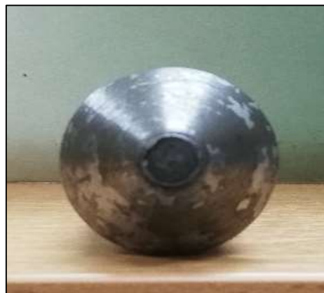
Figura 2-3: Contrapunto desgastado. Fuente: (Autores, 2019).
