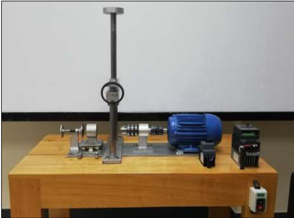
Figura 1-3: Estado actual de la máquina de fricción y desgaste. Fuente: (Autores, 2019).
